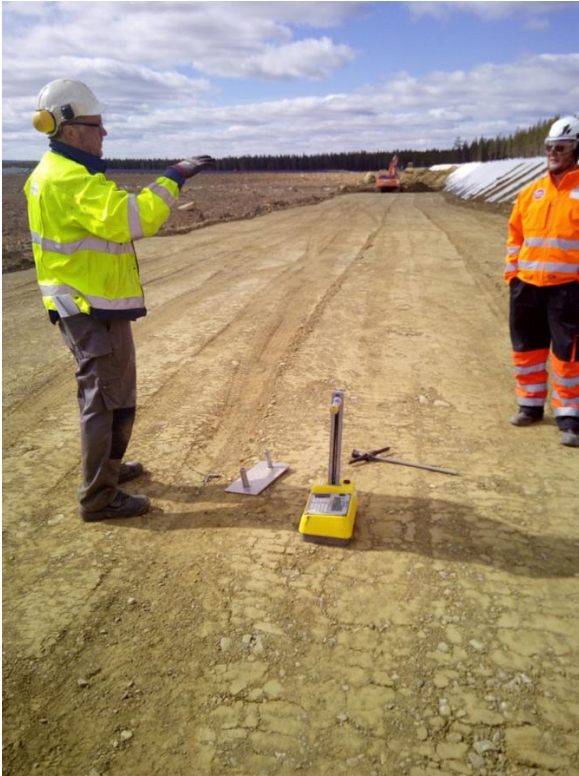
KUVA 14. Troxler-mittauslaitteella tiiviyksasteen mittaamista moreenitiivisteestä
