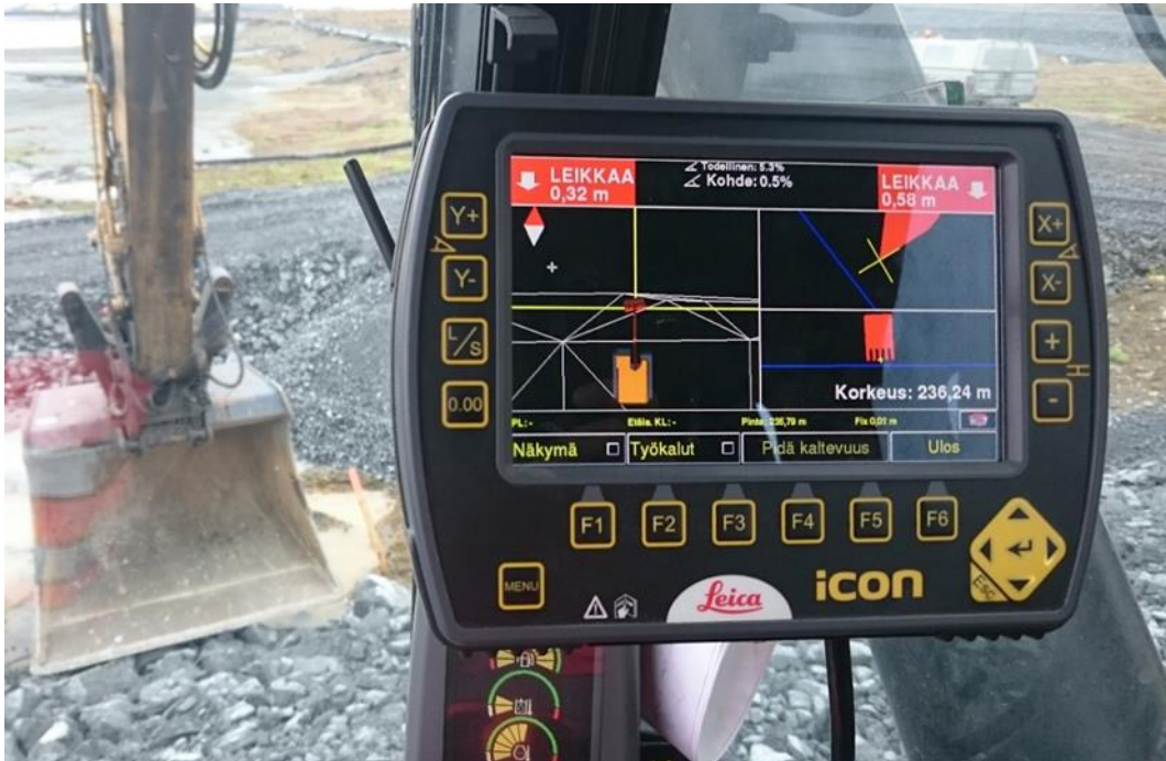
KUVA 22. 3D-koneohjauksellisen kaivinkoneen näyttö
