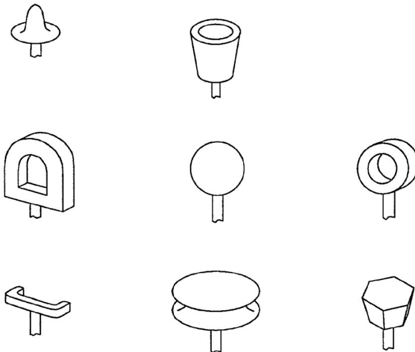
KUVA 9. Esimerkkejä muodoista jotka voidaan tunnistaa yksin tuntoaistin avulla. (SFS-EN 61310-1)
