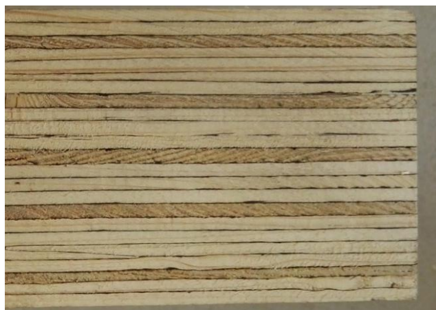
KUVA 26. Liitoskokeissa käytettävä LVL -levy on Stora Enson X -laatua, jossa 5 viilukerrosta on ristiinliimattu kohtisuoraan pääasialliseen viilujen suuntaan nähden (Miettinen 2017-10-11).
