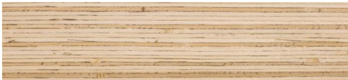
KUVA 4. LVL -levyn poikkileikkaus, jossa näkyy erisuuntaisia 3 mm paksuisia viilukerroksia. (LVL by Stora Enso 2017, 4)
