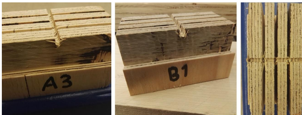
KUVA 64. Koekappaleet A3 ja B1 koestuksen jälkeen. Puunsiyät kuormituksen suunnassa (Miettinen 2018-02-05)
