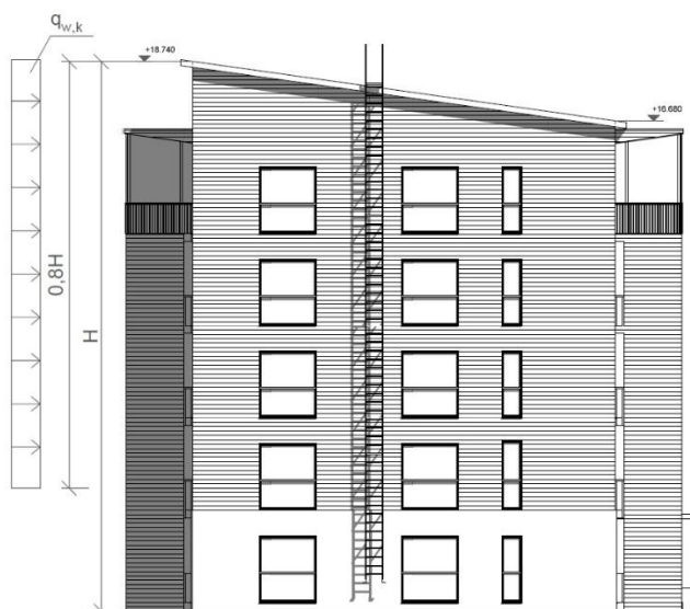
KUVA 21. 0,8H vyöhykkeellä vaikuttava tuulenpaine tasaisena kuormana (Puuinfo.fi c. 2014, 5; muokannut Miettinen 2018-01-16)
