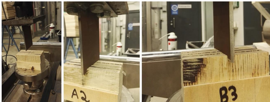
KUVA 63. Koejärjestely LVL -levyjen reunapuristuslujuuden määrittämiseksi (Miettinen 2018-02-5)
