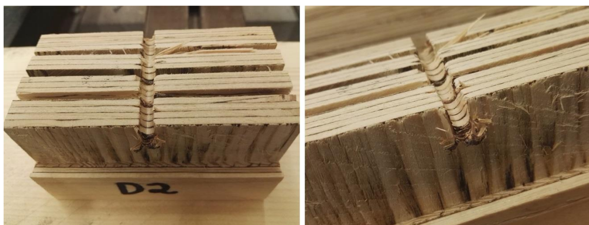
KUVA 65. Koekappale D2 koestuksen jälkeen, puunsiyät kohtisuorassa kuormitukseen (Miettinen 2018-02-05)
