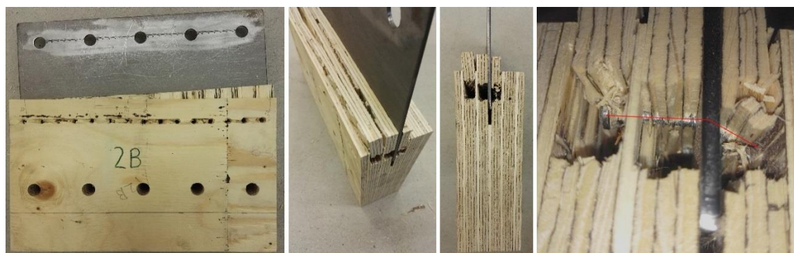
KUVA 51. Koekappaleen B2 murtotapahtuman kuvaus, jossa näkyy puusta murto. Ruuvit ovat kuorman vaikutuksesta taipuneet. (Miettinen 2017-11-06.)
