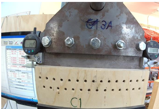
KUVA 45. Kuvakaappaus videotallenteelta, jolta kerättiin siirtymät koekappaleen molemmissa reunoissa (Miettinen 2017-11-01)
