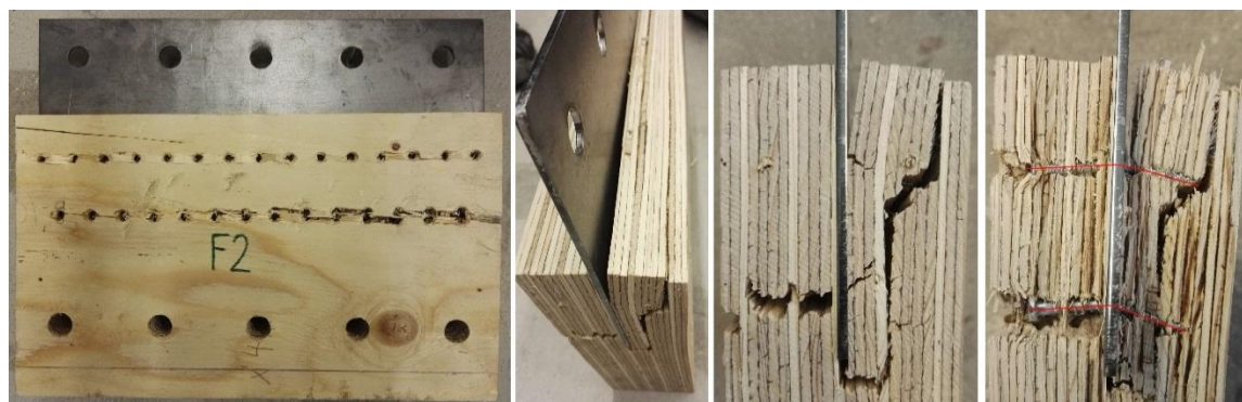
KUVA 57. Koekappaleen F2 murtotapahtuman kuvaus, jossa näkyy puusta murto. Ruuvit ovat kuorman vaikutuksesta taipuneet. (Miettinen 2017-11-06.)
