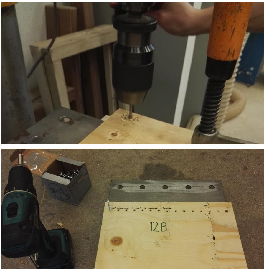
KUVA 42. Koekappaleisiin tehtiin esiporaus 5 mm ruuveille, ja ruuvit ruuvattiin paikoilleen akkupora-koneella (Miettinen 2017-10-02)
