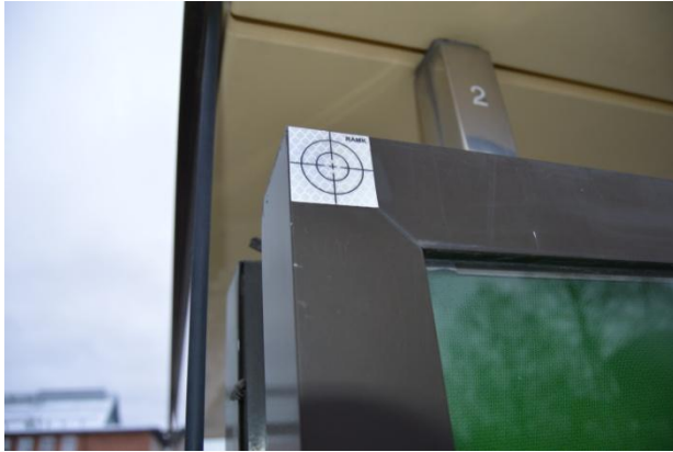
Kuvio 6. Tähystarra kiinnitettynä linja-autopysäkkiin
