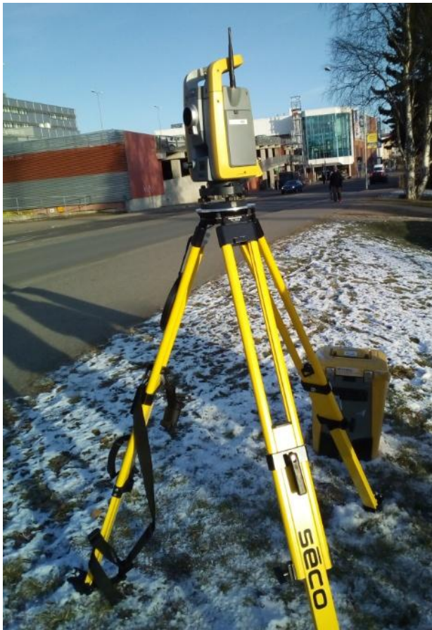
Kuvio 5. Trimble S6 -takymetri apupistemittauspäivänä
