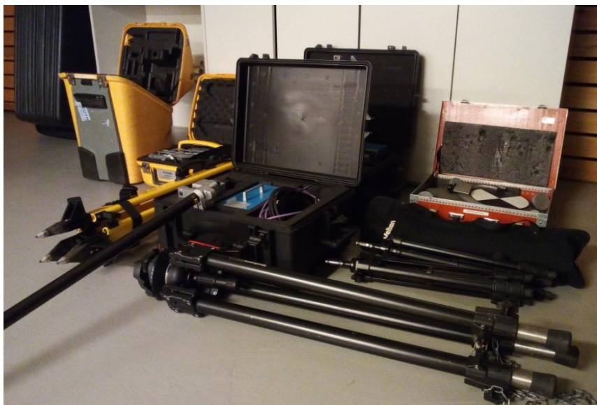
Kuvio 4. Käyttämäni mittauskalusto. Kuvan oikeassa laidassa, avoimessa laati- kossa näkyy käyttämäni valkomusta tasomainen tähys
