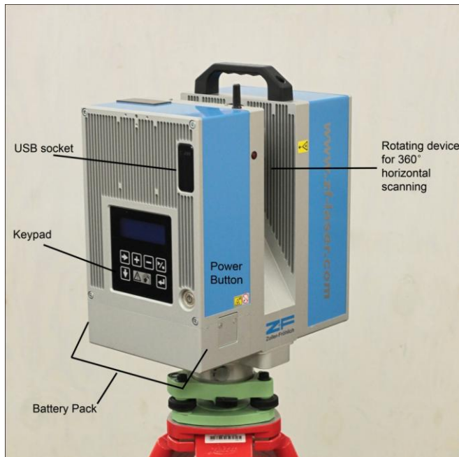
Kuvio 2. Käyttämäni laserkeilain Zoller+Fröhlich IMAGER 5006i (Geospatial Modeling & Visualisation 2011)
