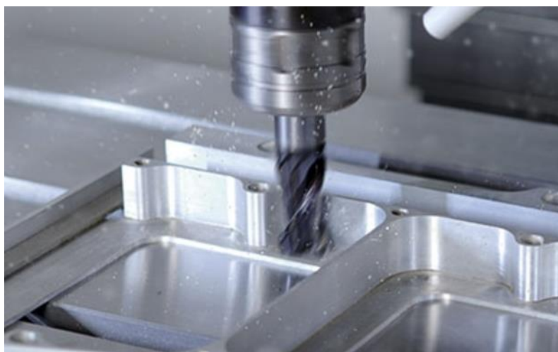
Kuva 2. Lastuava työstö jyrsimällä (Wihuri Tekninen Kauppa/Työstökoneet 2018)
