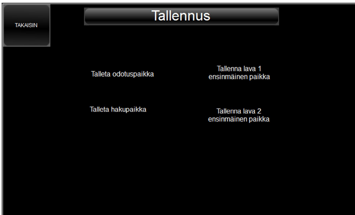
Kuva 33. Tallennusvalikko, nappien avulla pystytään tallentamaan akseleille haku-, odotus- ja lavapaikan koordinaatit, jotta robotti osaa siirtyä esimerkiksi hakupaikasta lavapaikkaan.
