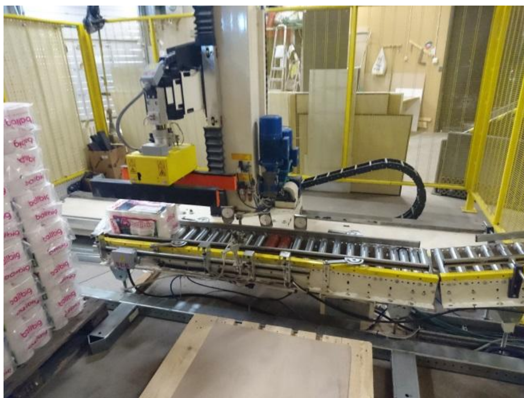
Kuva 17. Robotin odotuspaikka, johon on saapunut yksi pakkaus. Vieressä lava, johon pakkauksia on pinottu päällekkäin.
