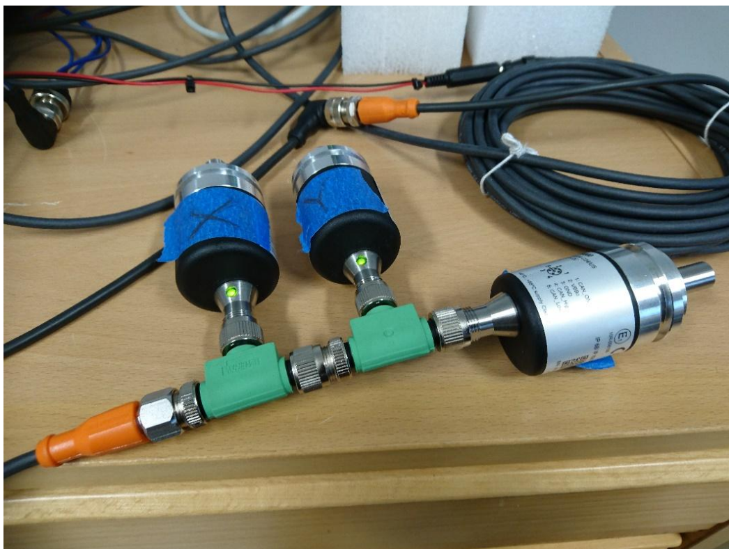
Kuva 35. Absoluuttipulssiantureiden testikytkentä. Anturit kytketään samaan väylään sarjaan ja viimeisessä kytkentäpisteessä pitää olla päätevastus, jotta väylä toimii.
