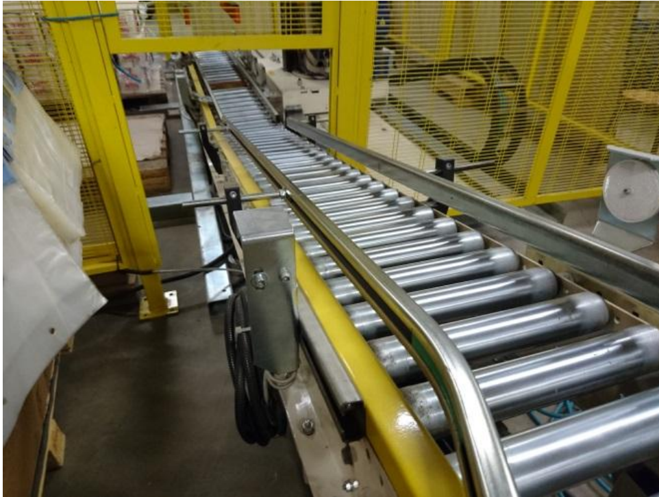
Kuva 18. Kuljetin jota pitkin pakkaukset tulevat. Valokennot tunnistavat saapuvat pakkaukset.
