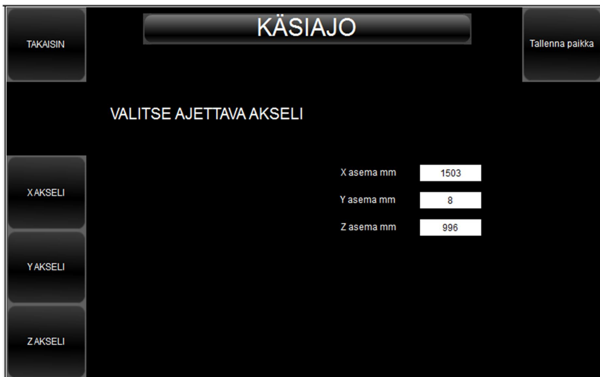
Kuva 32. Käsiäjo valikon ulkoasu. Valikosta pystytään valitsemaan, mitä akselia ajetaan ja näkyy myös akselin sijainti millimetreinä.
