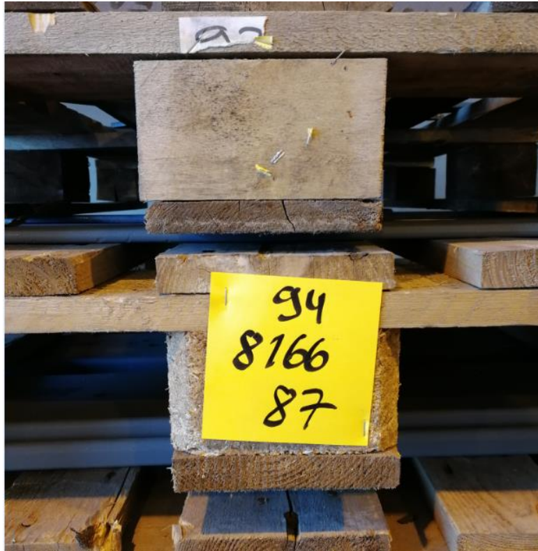
Kuva 7. Lavaan kiinnitettävä lappu, josta selviää laivan numero, lohkon numero sekä toimituspaikka.
