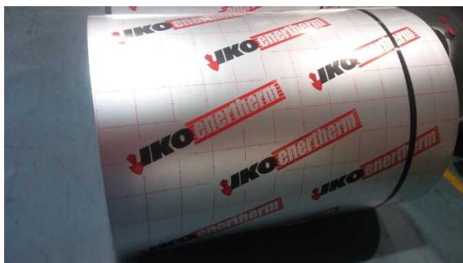
Kuva 2. Valmis polyuretaanipinnoite rulla 2-väripainatuksella
