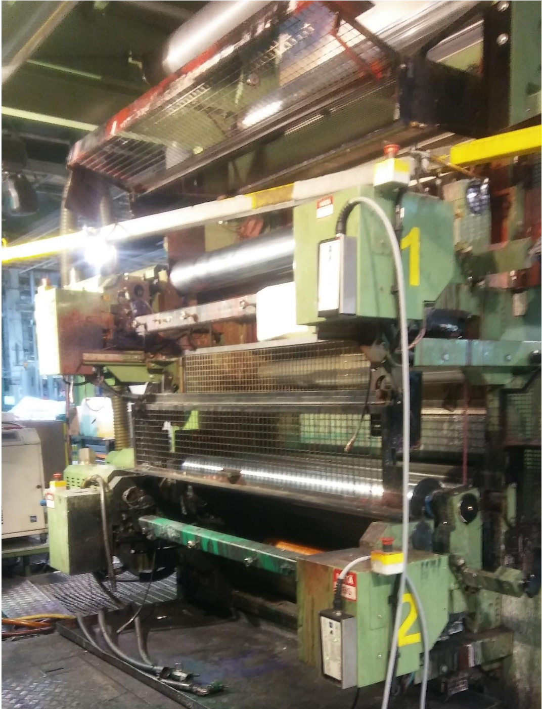
Kuva 6 Painoyksikkö painoväriäaltaat ja painovärikammio purettuna
