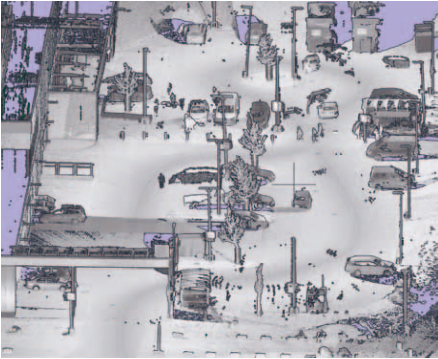
Kuva 1. Laserkeilaimella tuotettu pistepilvi kahdella eri ajanhetkellä (eri värisinä) tieympäristöstä. Mitä enemmän muutoksia tiealueella on, sitä vaikeampaa on paikantaa autonominen auto reaaliajassa. Mitä enemmän muutoksia tieympäristössä on, sitä kiinnostavempaa aineisto on kartoituksen näkökulmasta. © Antero Kukko.
