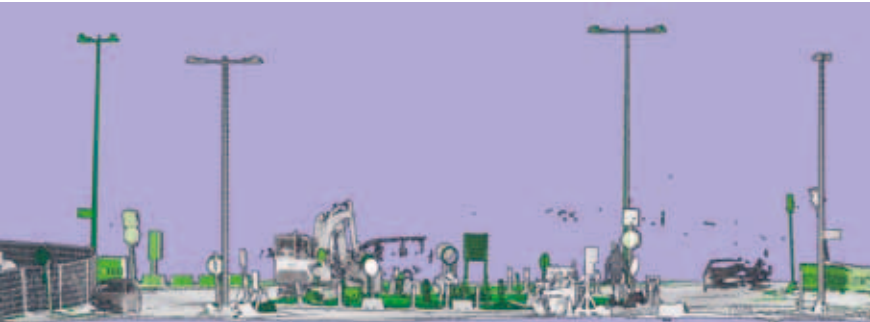
Kuva 2. Tietyön vuoksi muuttunut tieympäristö. Huonosti toteutettu autonominen auto pysähtyy tilanteeseen, jossa auton omat karttatiedot poikkeavat merkittävästi todellisuudesta. © Antero Kukko.
