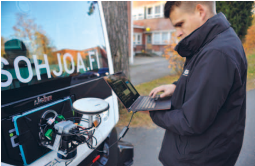
Kuva 4. Laserkeilauksen huippuyksikkö asensi omat konenäkölaitteet autonomisen SOHJOA-robottibussin eteen. © Juha Hyyppä
