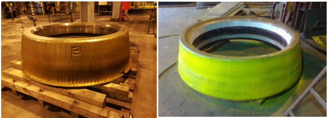
Kuva 14. Kulunut ja hitsattu murskaintela
