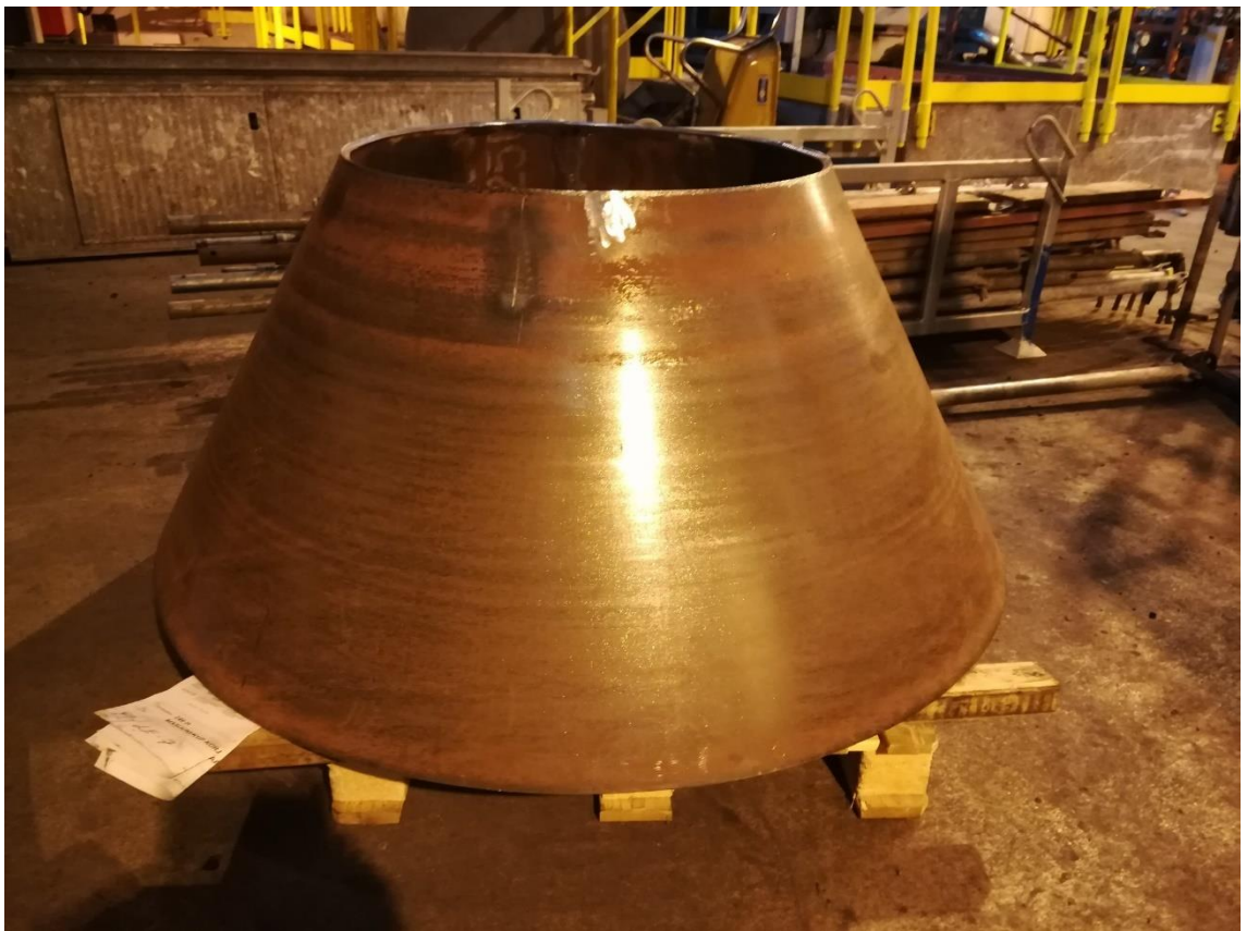
Kuva 17. Raekartion korjauspala asennusvalmiina.
