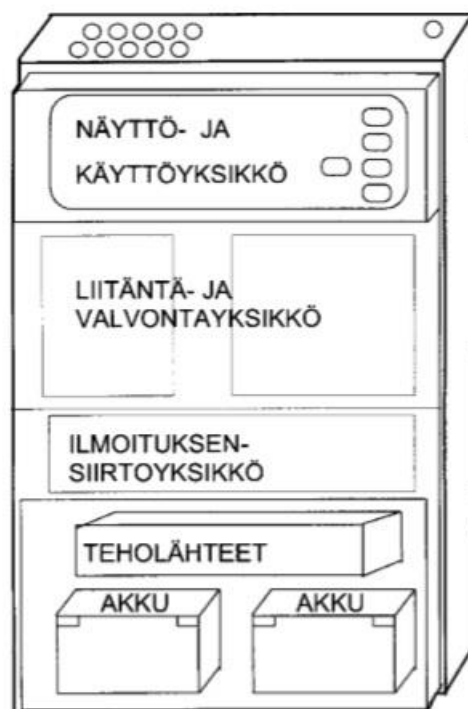
Kuvio 1. Keskuslaitteen rakenne (Holmén ym. 2004, 56)
