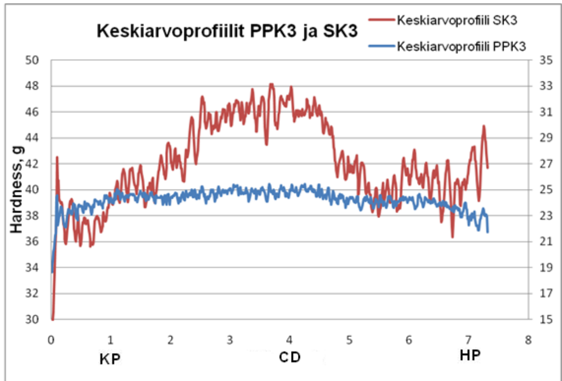
Kuva 19. Kovuusprofiilien keskiarvot PPK3:n ja SK3:n jälkeen.
