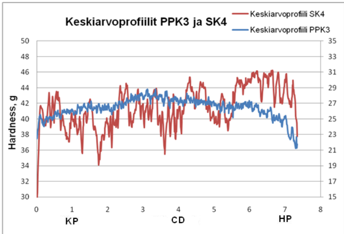
Kuva 22. Kovuusprofiilien keskiarvot PPK3:n ja SK4:n jälkeen.
