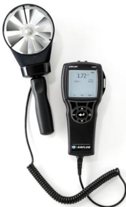
Kuva 17. Mikromanometri ja siipipyöranemometri ilman nopeuden mittausta varten.
