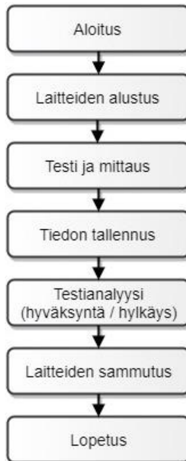
Kuva 3. Tyypillisen ATE-testauksen vaiheet yksinkertaistettuna.
