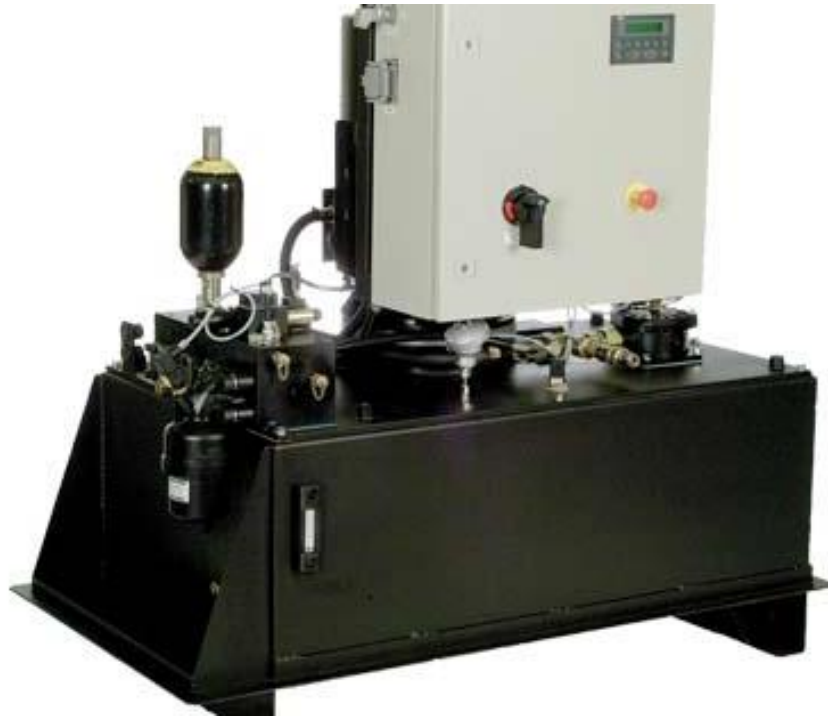
KUVA 12. Väsytykokeisiin tarkoitettu hydraulikojeisto (Kuva Zwick.fi)
