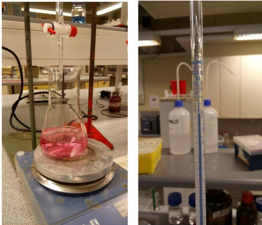
Kuva 11. Näytteet titrattiin 0,1M HCl-liuoksella.
