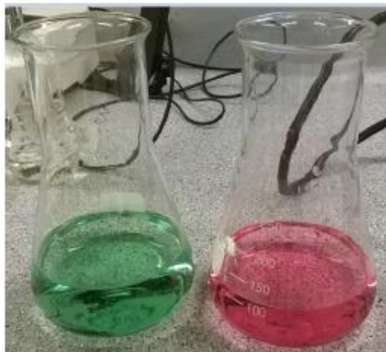
Kuva 4. Liuoksen väri ennen titrausta (vihreä) ja värin muutos ekvivalenttikohdassa (punainen). Titrauksessa käytettävä byretti ja magneettisekoittaja (voi sekoittaa myös käsin).
