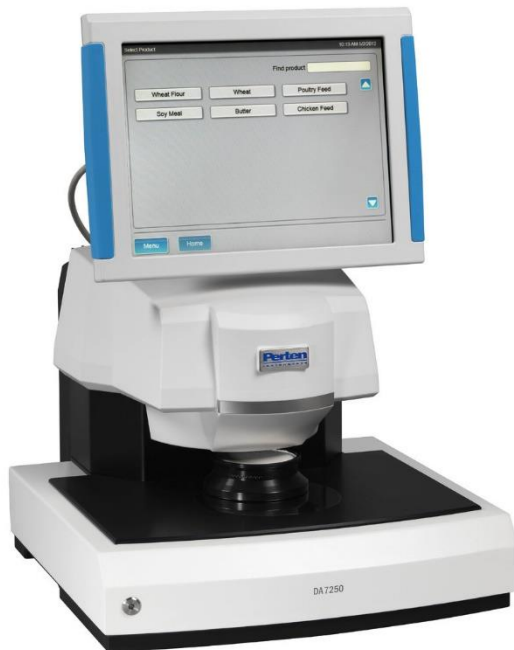
Kuva 1. Perten DA 7250 lähi-infrapunaspektroskopia (Perten DA 7250-analysaattori [viitattu 22.2.2018]).
