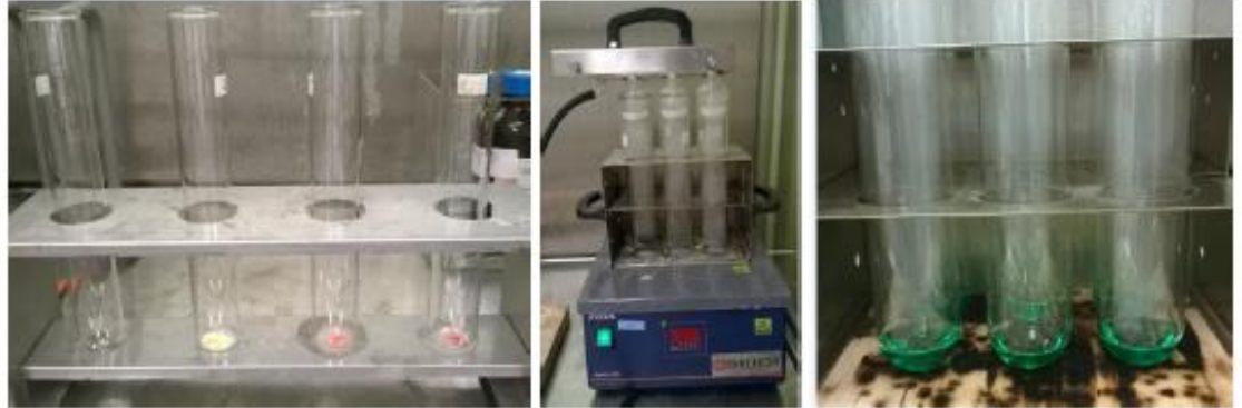
Kuva 2. Punnitut näytteet polttoputkissa, näytteet polttolaitteessa ja näytteiden väri polton jälkeen
