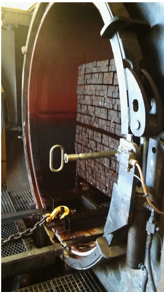
Kuva 4. Kyllästettyä puutavaraa sylinterissä.
