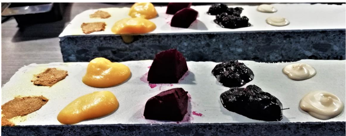
Kuva 14. Värjäntyvyyden testaus. Etualalla Dekofloor-koekappale.
