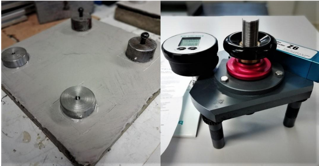
Kuva 5. Vetonapit liimattuna Dekofloor-koelaatalle ja mittauslaite.
