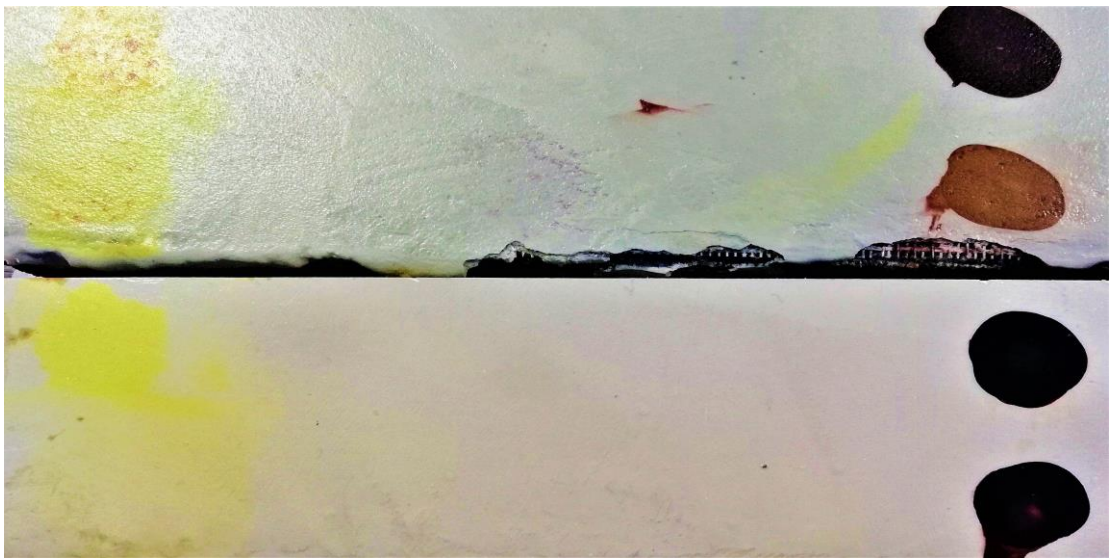
Kuva 15. Mikrosegmenttipinnoitteisiin jääneet tahrat testin seurauksena. Alempana Pavicem-mikrosegmentti, yläpuolella Dekofloor.
