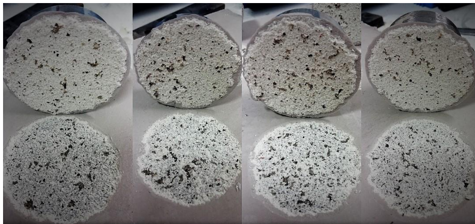
Kuva 6. Vetonapin murtopinta ja Pavicemin murtokohta betonipinnasta.
