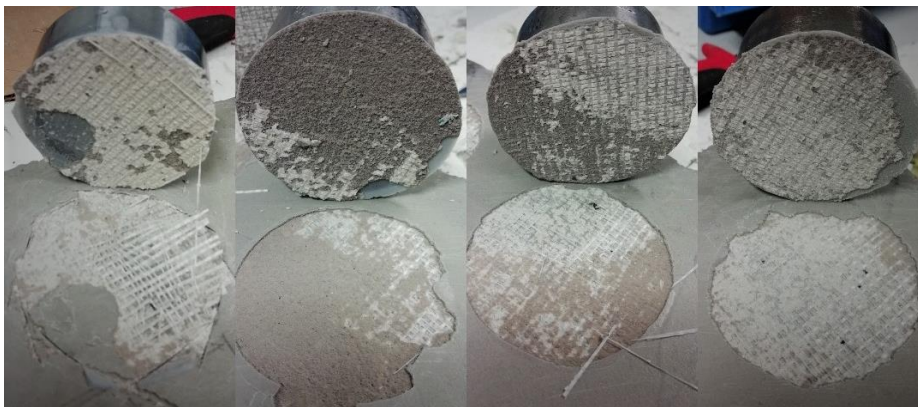
Kuva 11. Vetonapin murtopinta ja Dekofloorin murtokohta vedeneristeestä.
