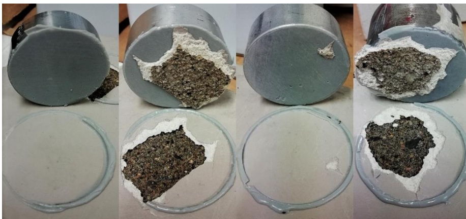
Kuva 8. Vetonapin murtopinta ja Pavicemin murtokohta vedeneristeestä.
