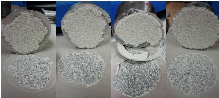
Kuva 7. Vetonapin murtopinta ja Pavicem-mikrosegmentin murtokohta kylpyhuonelaatan pinnasta.
