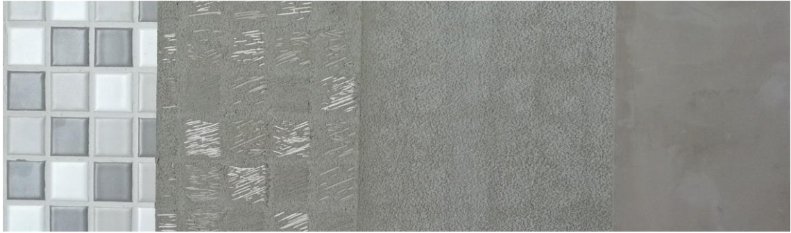
Kuva 16. Pavicem-mikrosementti vaihe vaiheelta laatan päälle asennettuna.
