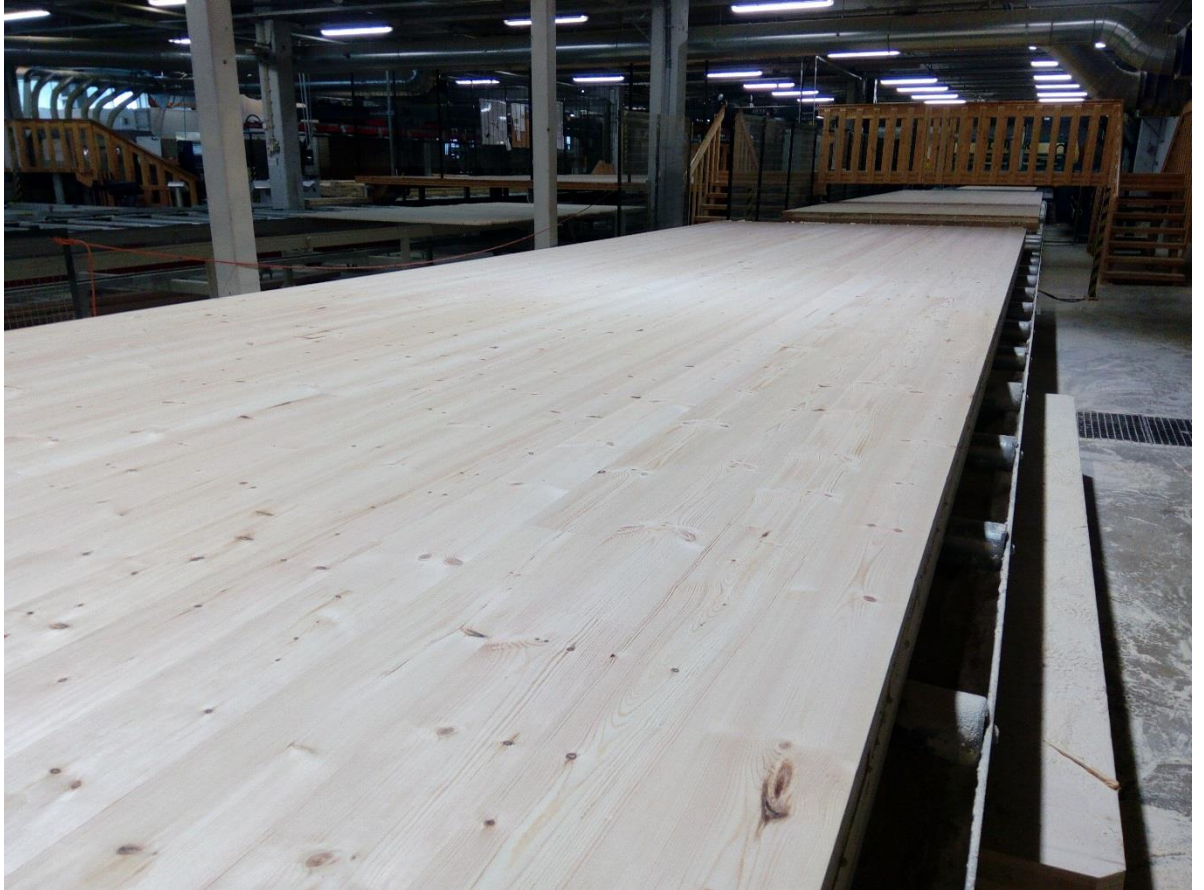
Kuva 8. L-mallin levy. Pinnanlaatu ei-näkyvä kuusi. Ei-näkyvässä levyssä voi olla myös höylävajaata pintaa.
