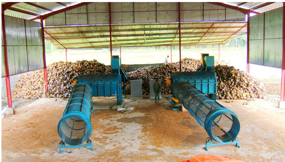
Kuva 3. Kuvassa on kookoskuidun kuivaamiseen tarkoitettu kuivausrumpu. Tällaisesta saisi muokkaamalla myös kastelurummun/3/.
