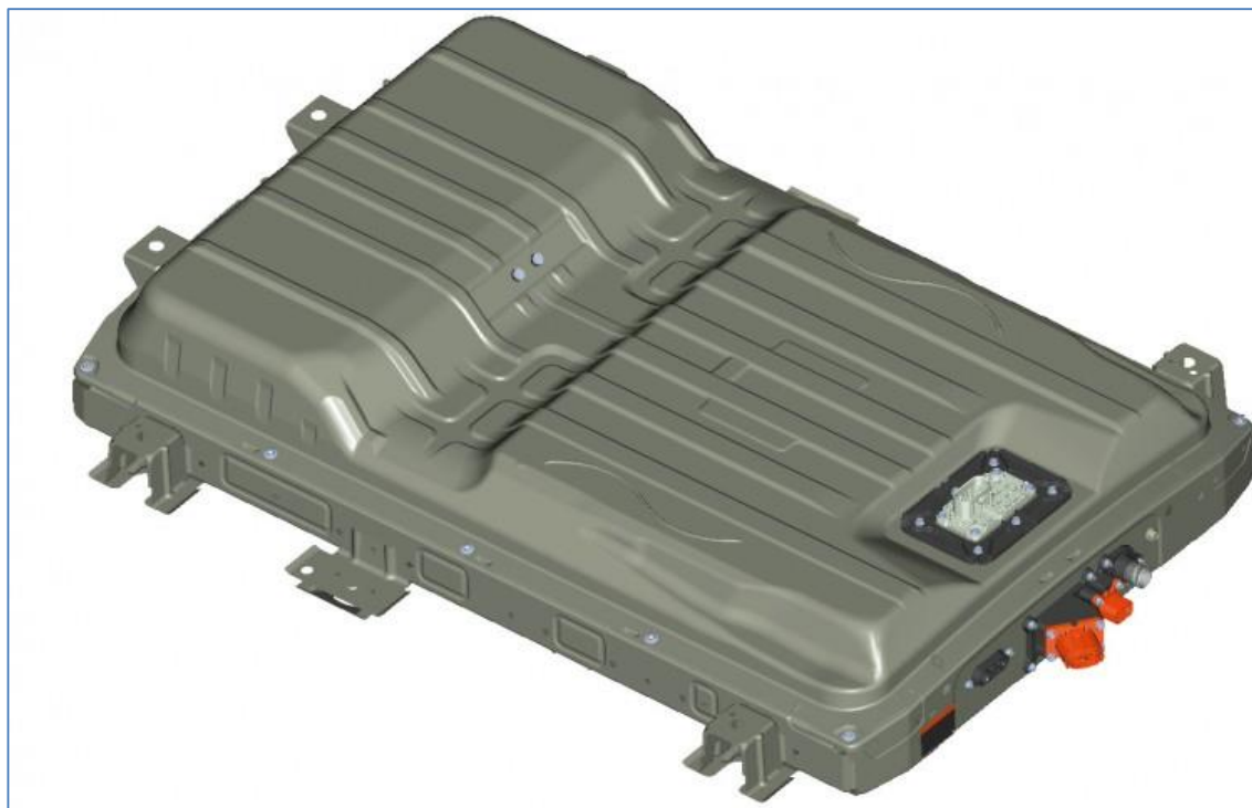
KUVIO 66. Nissan e-NV200 akusto. Ilmastoinnin kylmäaineputket liitetään akuston etupäästä sähkökytkentöjen vierestä (Loveday 2014.)
