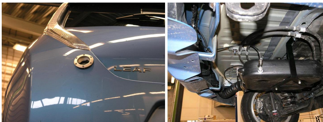
KUVA 9. Täyttökauluksen ja polttoainesäiliön sijainti (Kaha Mallikohtainen asennusohje 2012)
