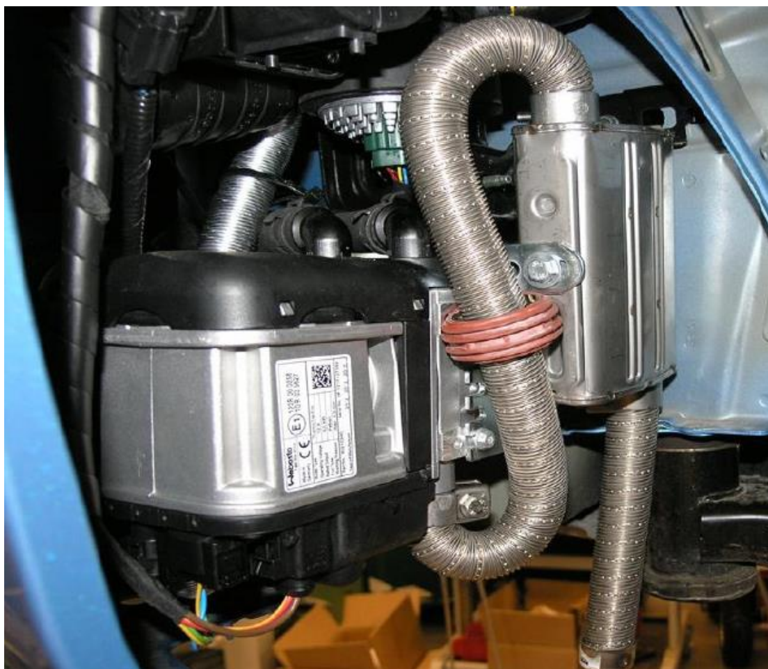
KUVA 4. Thermo Top Evo-vesilämmitin Nissan Leaf -sähköauton vasemman etupyörän etupuolella (Kaha Mallikohtainen asennusohje Nissan Leaf 2012, muokattu)
