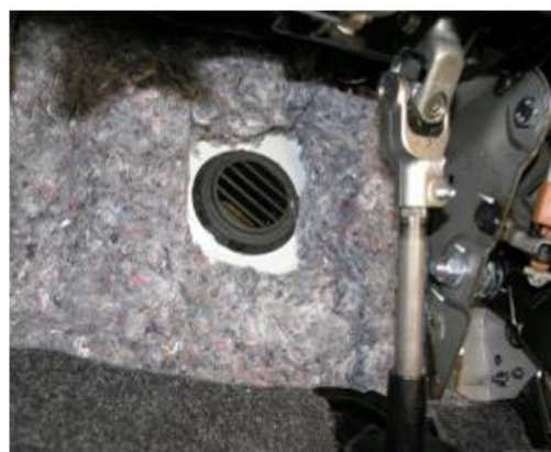
KUVA 12. Ilmasuulakkeen läpivienti kuljettajan puolelle (Kaha mallikohtaiset asennusohjeet 2015.)
