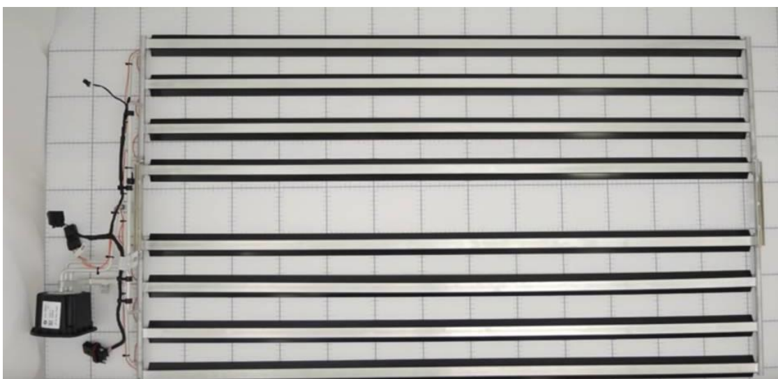
KUVA 14. BMW i3:n akuston jäähdytysputkisto (Bower & Ritter 2015)
