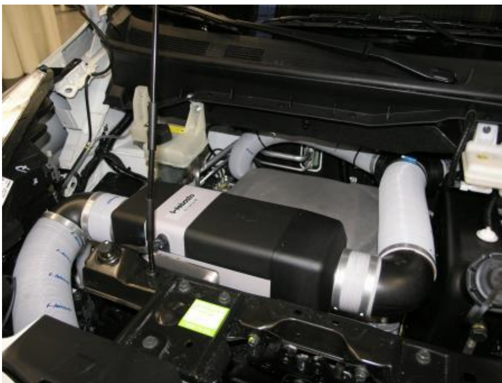
KUVA 10. Webasto Air Top Evo 40-lämmitin asennettuna Nissan e-NV200 moottoritiilaan. Oikealla jarrunestesäiliön alla musta polttoainesäiliö ja sen korkki (Kaha mallikohtaiset asennusohjeet 2015.)
