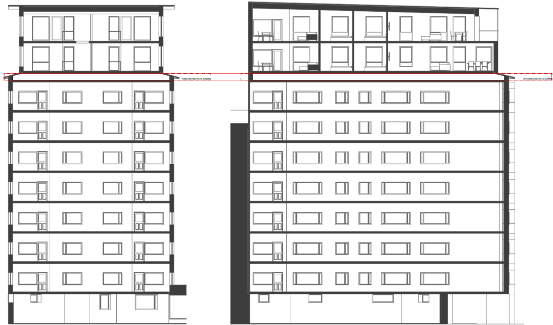
Kuva 14. Leikkauspiirustukset, joissa näkyy suunniteltu tekniikkakerros (Pinja Liljeström, 2018)
