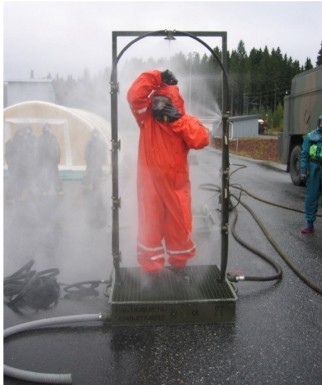
Kuva 11. Puolustusvoimilla käytössä oleva partiosuihku MAVA 300 toiminnassa.
