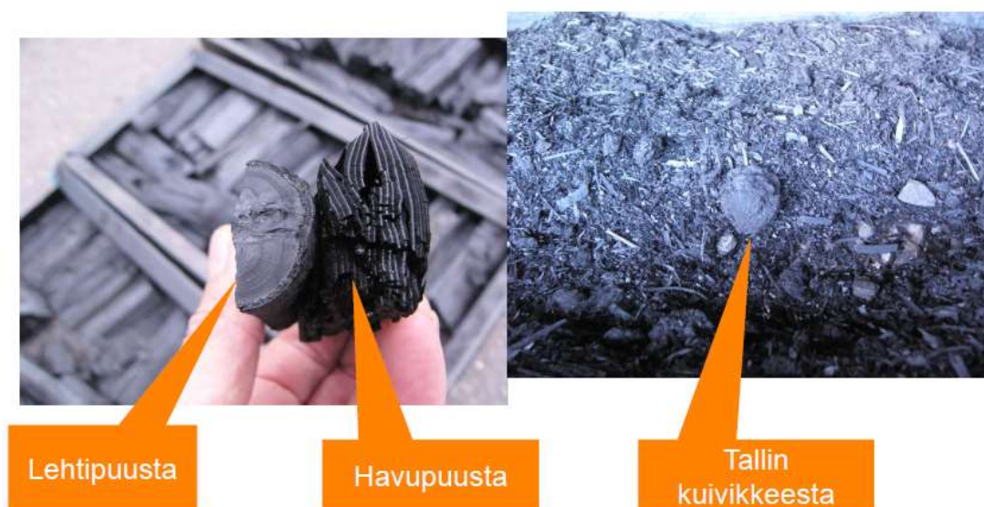
Kuva 11. Eri raaka-aineista tehtyjen biohiilten rakenteelliset erot (Tiilikkala 2015).
