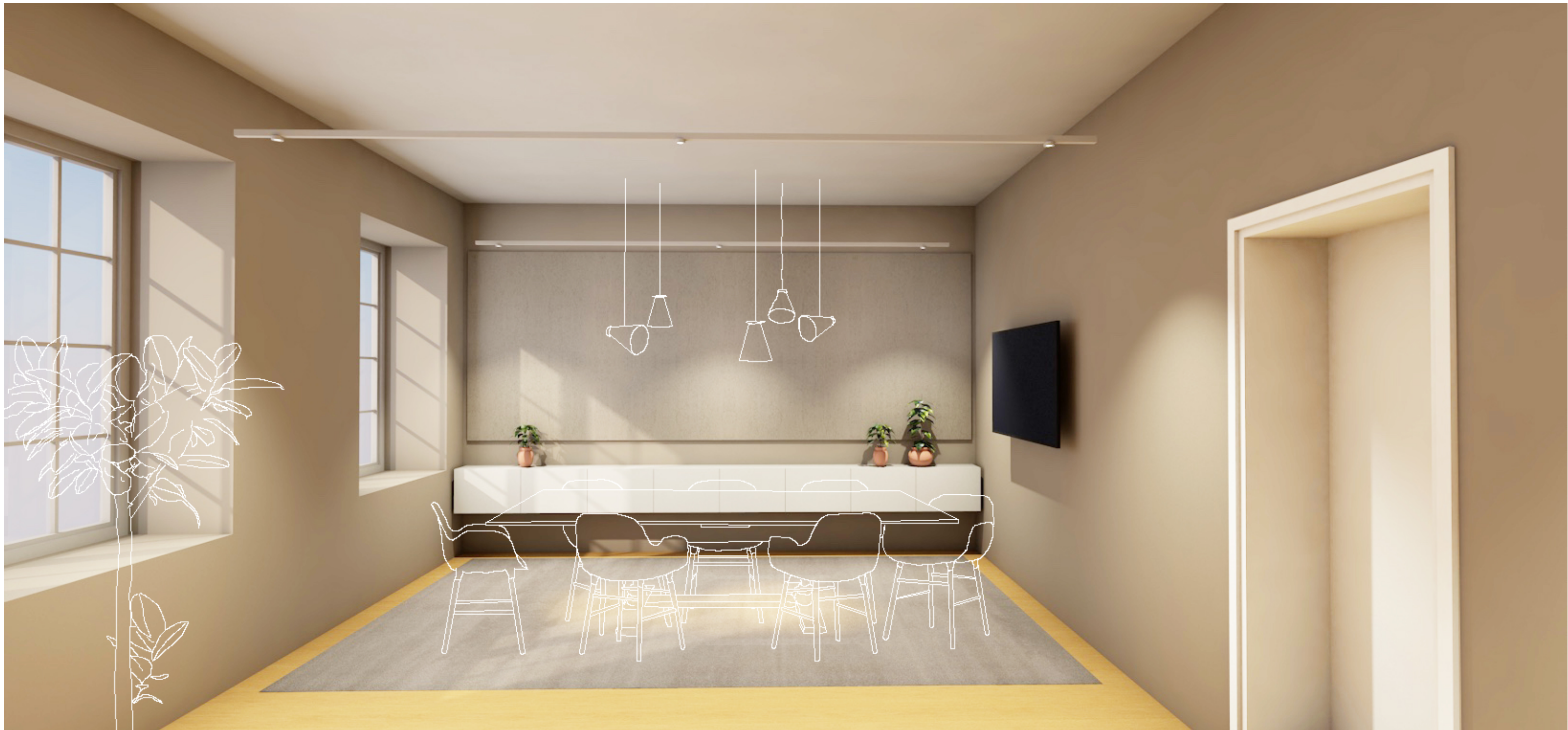
Kuva 25. Näkymä neuvotteluhuoneen toiseen pätyyn. Seinällä on akustolevyjä, ja lisäksi ikkunaseinälle asennetaan katosta lattiaan ulottuvat verhot pehmentämään äänimaailmaa. Tähän tilaan, kuten muihinkin tiloihin, tuodaan kasveja parantamaan lisäämään viihtyisyyttä.
