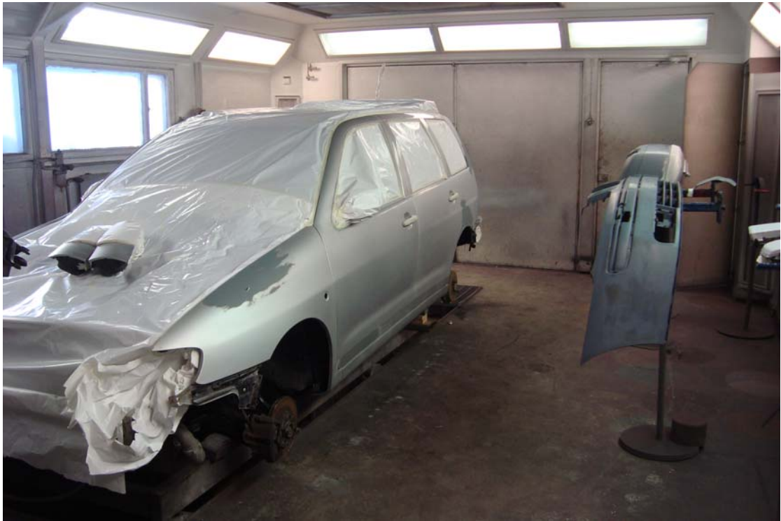
KUVA 5. Auto pohjatöiden jälkeen
