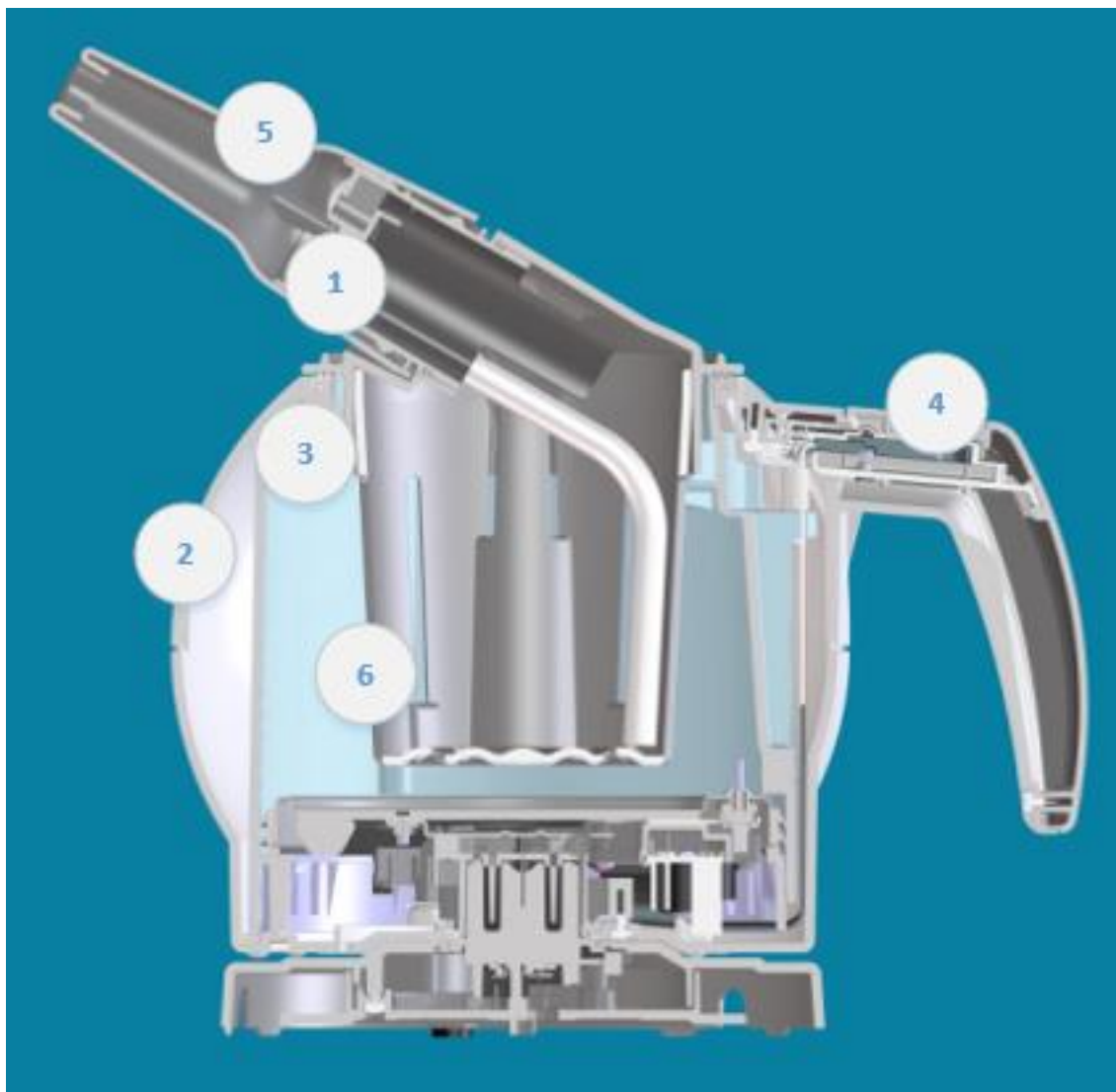
Kuva 3. Wello2 laitteen teknologia (Hapella Oy)
