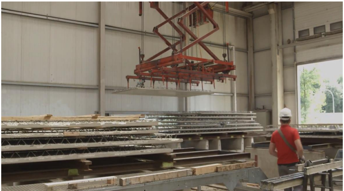
Kuva 8. Filigran-laatan nostaminen tehtaalla. Kuva: Samuli Nylander 2018.
