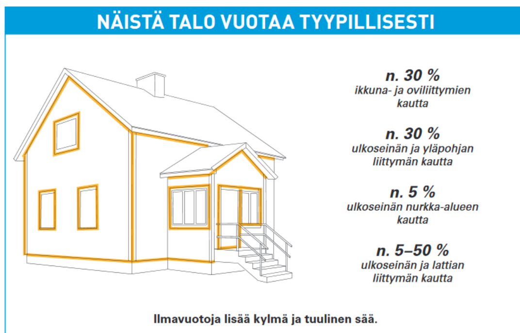
Kuva 25. Ilmavuotojen tiivistämisellä on merkittävä vaikutus rakennuksen energiatehokkuuteen (Oulun rakennusvalvonta 2013c).
