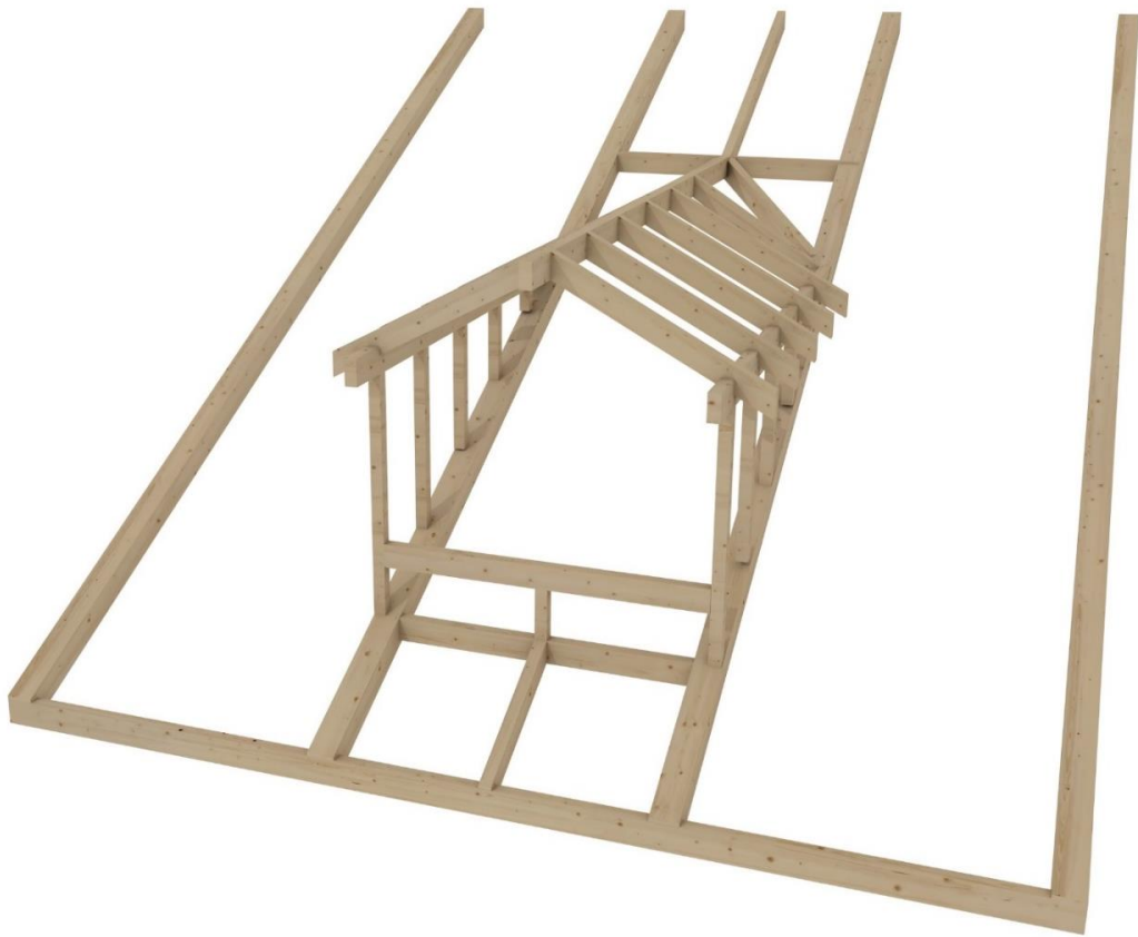
Kuva 36. Kattolyhdyn rakenteiden periaatekuva, leikkaus suunnittelukohteen 3D-mallista
