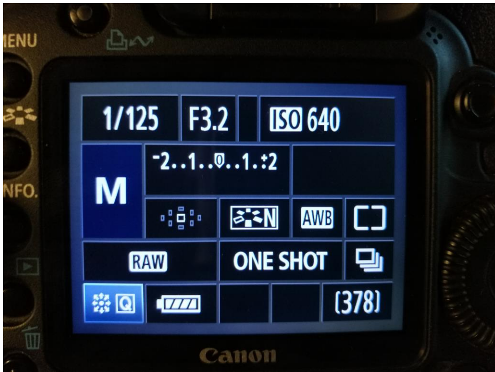
Kuva 47. Canon EOS 5D Mark II- kameran asetukset takkahuoneessa kuvatessani. Asetukset olivat käytössäni tilanteessa, jossa luonnonvaloa oli runsaasti.
