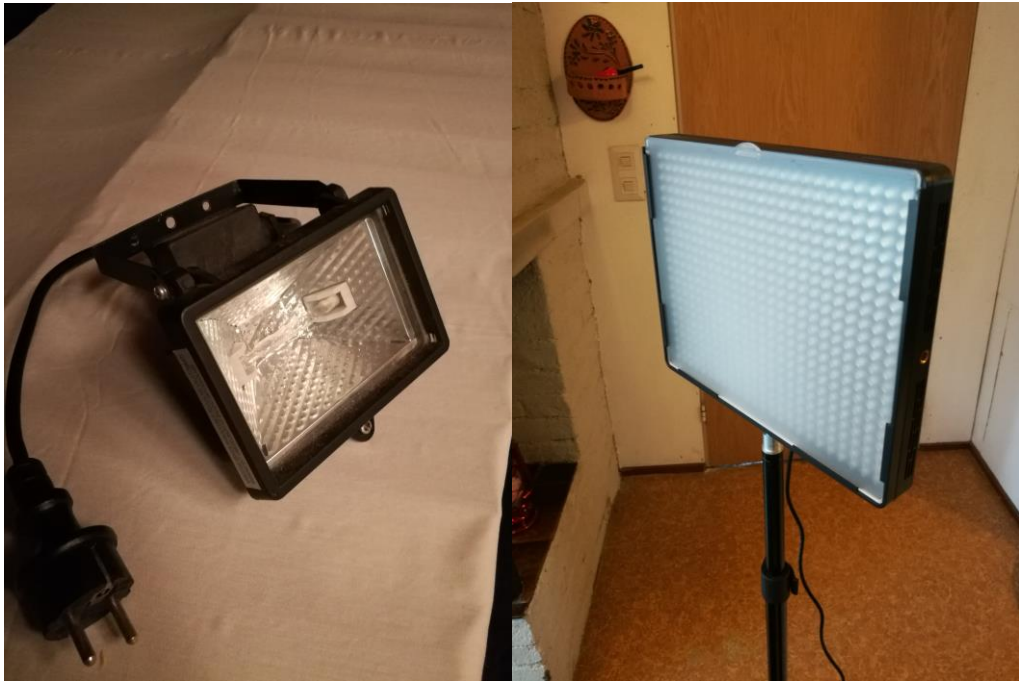
Kuva 49. Kuvauksissa käyttämiäni valaisimia. Oikealla oleva LED-valaisin on varustettu värilämpötilan säätimellä.
