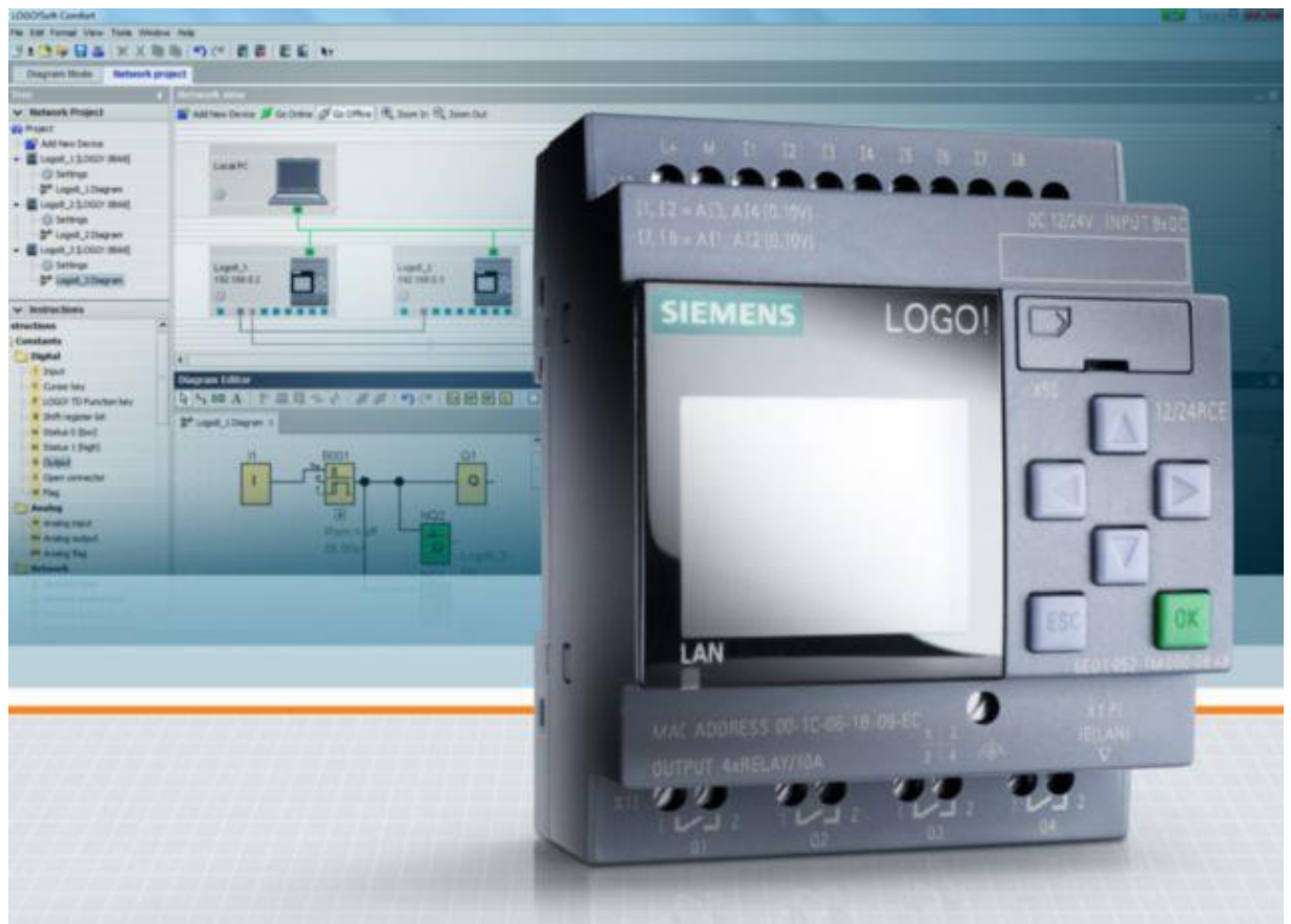
Kuva 9. Siemens Logo! 8 -perusmoduuli sekä lohkokaavio-ohjelmiston käyttöliittymä taustalla. /15/
