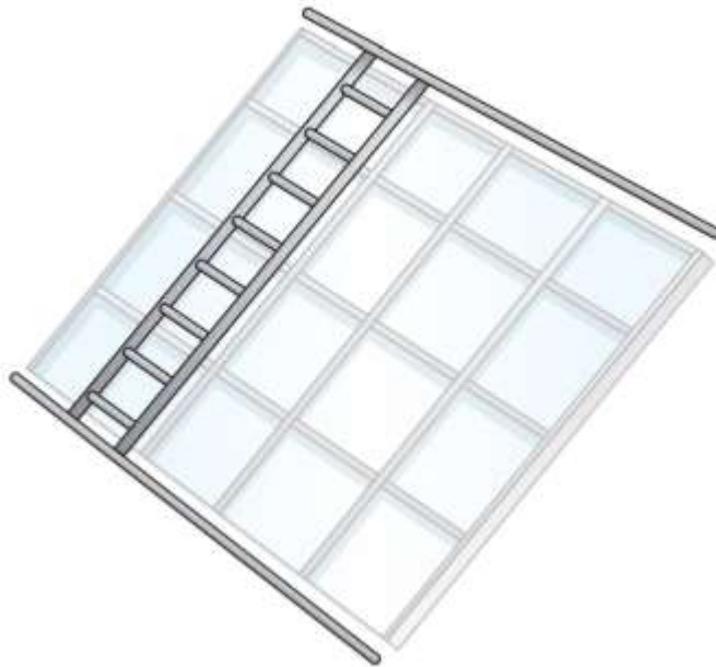
KUVA 12. Ulkopuolinen huoltotikasjärjestelmä (Sapa käsikirja, 2015)
