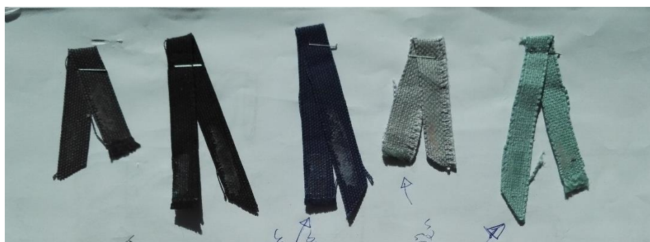
Kuva 11. Materiaalinäytteet liiman kuivumisen todentamisesta.
