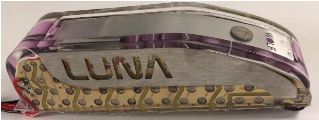
KUVA 26. Luna Cyclen johdinliitostekniikkaa hyödyntävä akkupaketti (Electricbike 2018)
