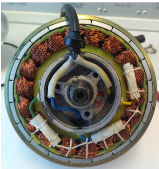
KUVA 5. Tyypillisen napamoottorin staattori ja roottori
