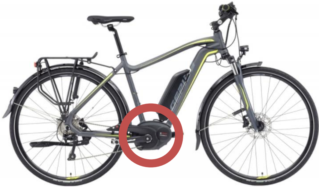
KUVA 7. Keskiömoottorin sijainti (Sähköfillari n.d b, muokattu)
