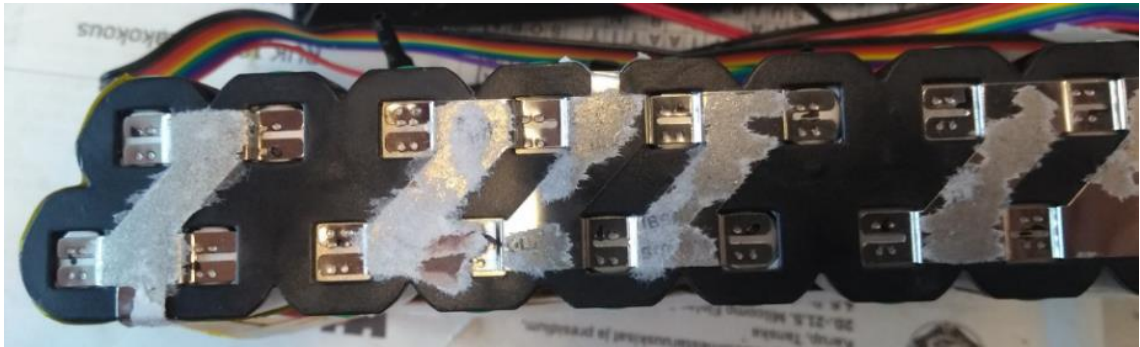
KUVA 10. Akkupaketin kennojen kytkentöjä.
