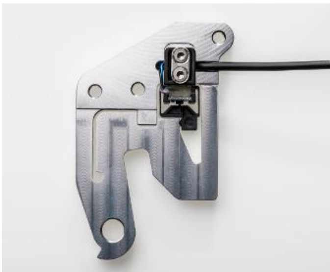
KUVA 16. Momenttianturi (Idbike n.d)
