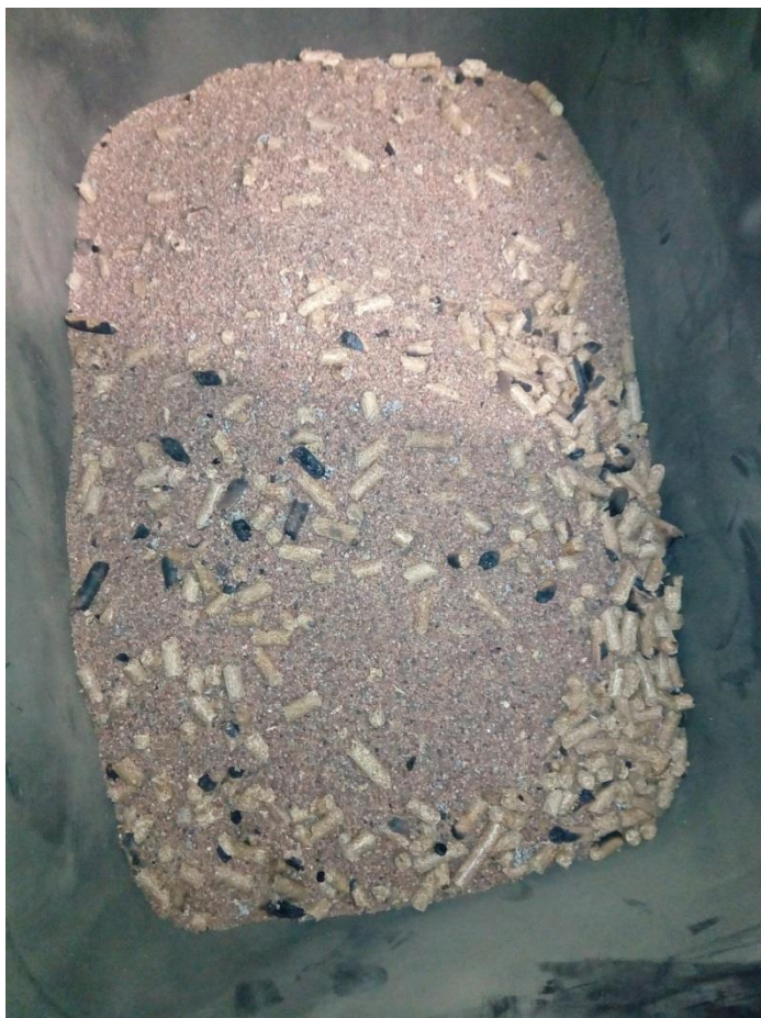
KUVA 45. Pohjatuhkayhteen kautta tyhjennetyssä kattilahiekassa oli paljon palamatonta polttoainetta seassa.
