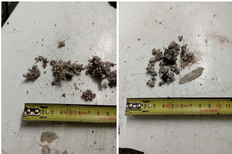
KUVAT 43 ja 44. Sintraantunutta hiekkaa. Kappaleet pysyivät pieninä ja tulivat hiekan mukana ulos kattilasta tuhkanpoistoyhteen kautta.
