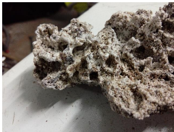
KUVAT 29 ja 30. Paloja isosta arinan ilmasuutinten päällä olleesta sintraantuneesta kappaleesta. Osa hiekasta oli sulanut.
