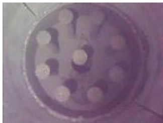
KUVA 4. Endoskoopilla otettu kuva arinasta ylhäältäpäin tyhjänä.
