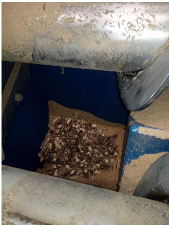
KUVA 40. Sulkusyötin ylhäältäpäin huoltoluukun kautta kuvattuna. Sulkusyöttimessä oli ilmeisesti haketta edellisen polton jäljiltä.
