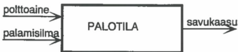
KUVA 2. Palotilan energiatase (Huhtinen ym. 2000, 95).
