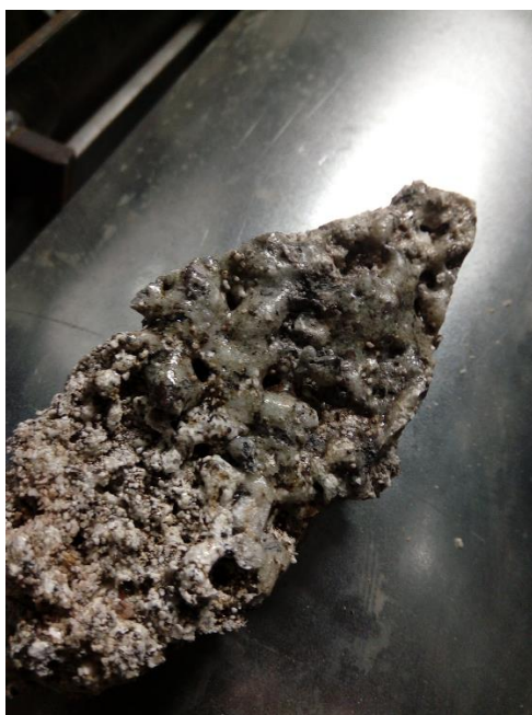
KUVAT 29 ja 30. Paloja isosta arinan ilmasuutinten päällä olleesta sintraantuneesta kappaleesta. Osa hiekasta oli sulanut.
