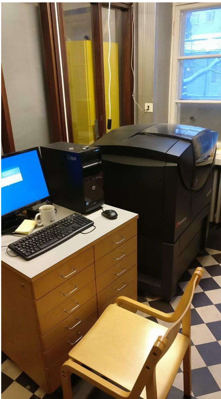
Kuva 17. Koulun Objet 3D-tulostin. Tulostimen koko on 87 x 120 x 73,5 cm ja paino 410 kg.
