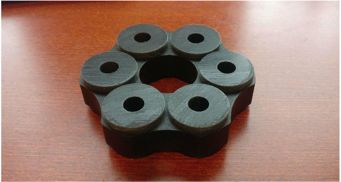
Kuva 20. Valmis kappale alapuolelta, jossa oli tukiainetta.
