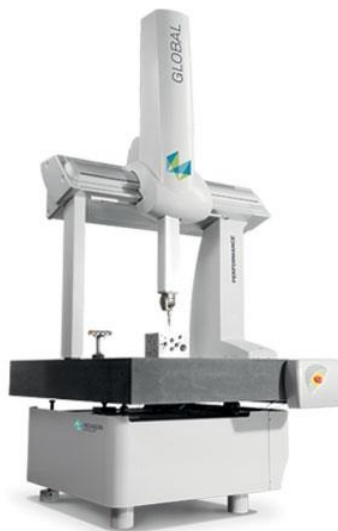
Kuva 5. Hexagon Global Performance, keskikokoinen koordinaattimittauskone [4].
