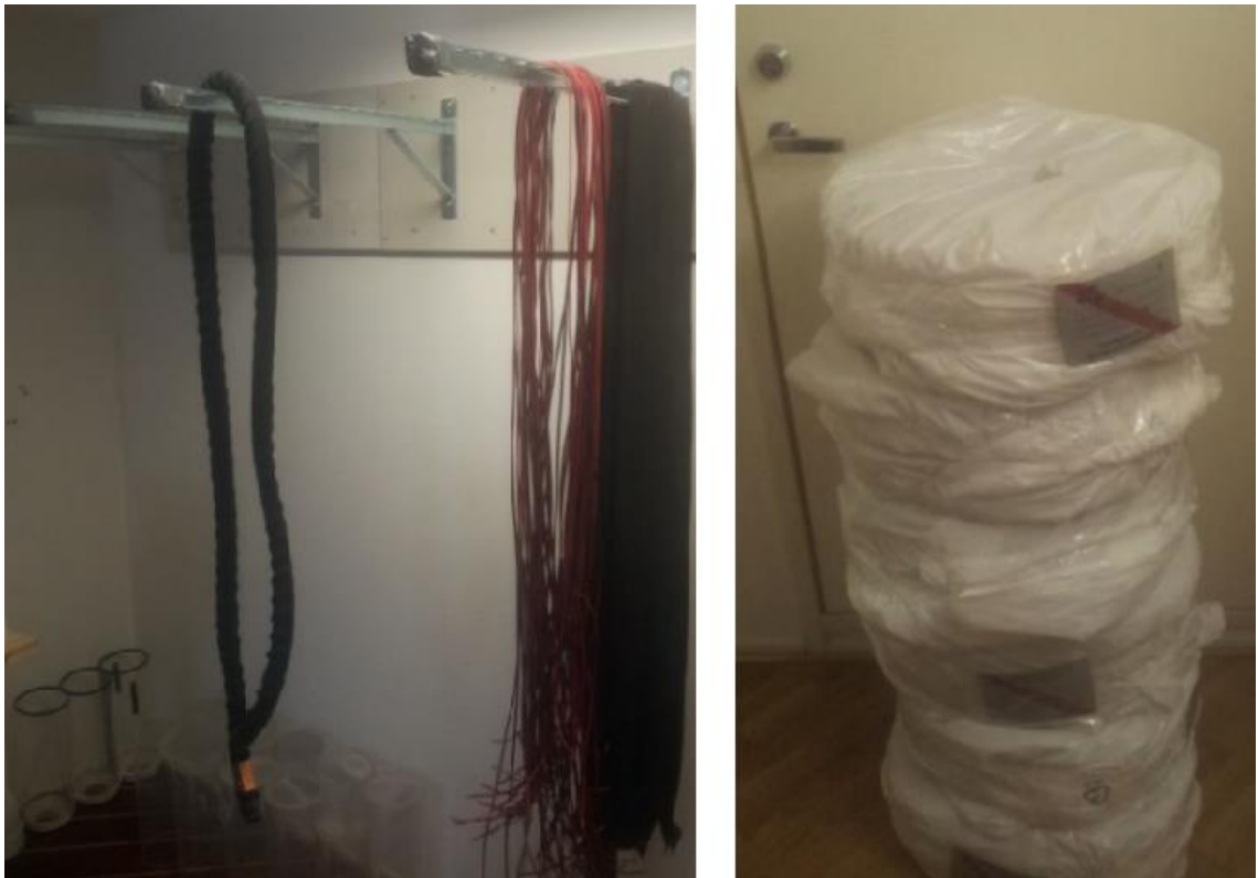
Kuva 6. Valmis imuriletku, sähköjohto ja kangaspäällyste imuriletkuun sekä muovista imuriletkumateriaalia kerällä.
