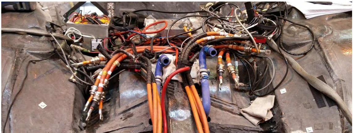
Kuva 2. Vanha johtosarja osittain purettuna auton keulalla (kuva Emil Martinen 2016)
