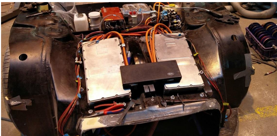
Kuva 8. Osien ja johtosarjan sovitusta auton keulalle (kuva Emil Marttinen 2017)
