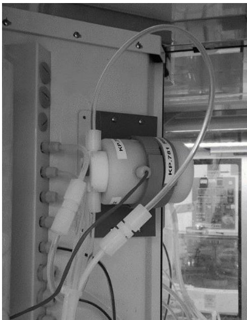
Kuva 18. Refraktometri asennettuna CMP-laitteen kiillotusmoduuliin.
