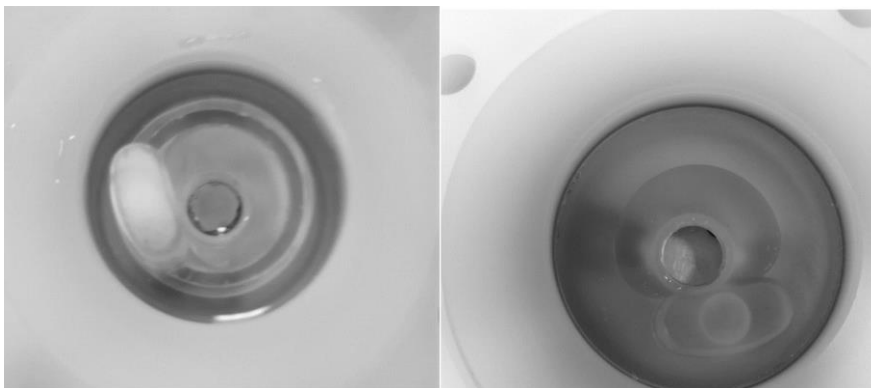
Kuva 19. Vasemmalla likaantunut prisma ja oikealla puhdas prisma.
