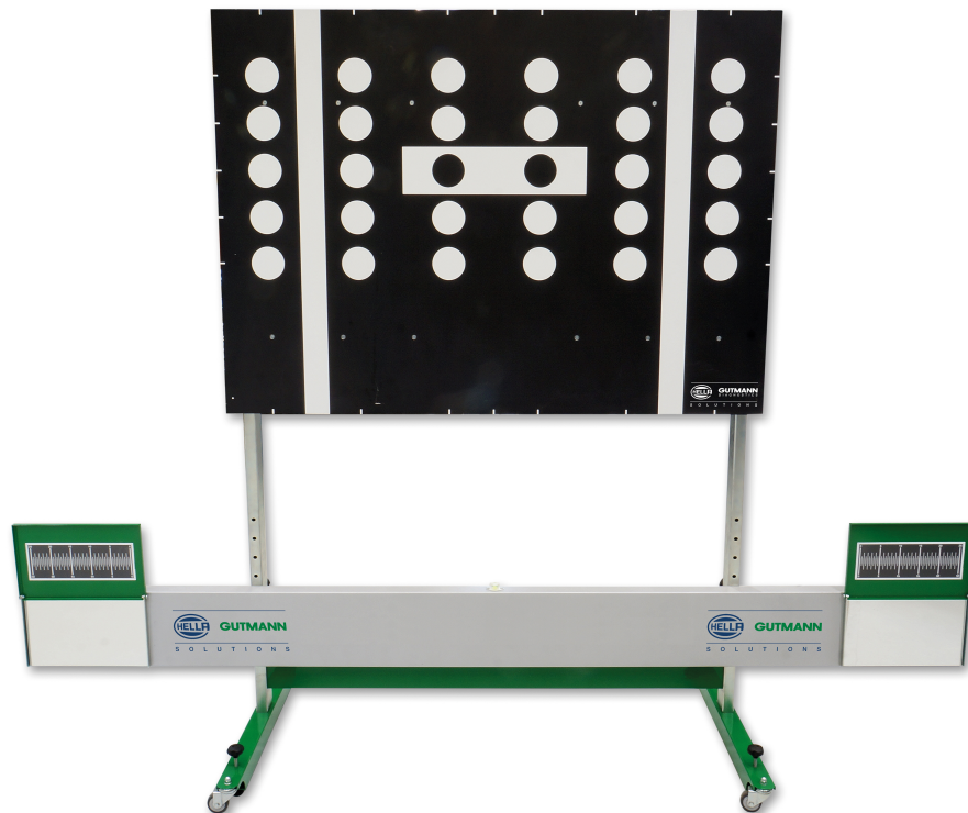
Kuva 8. Hella Guttman CSC Tool -kalibrointitaulu [Press Images].
