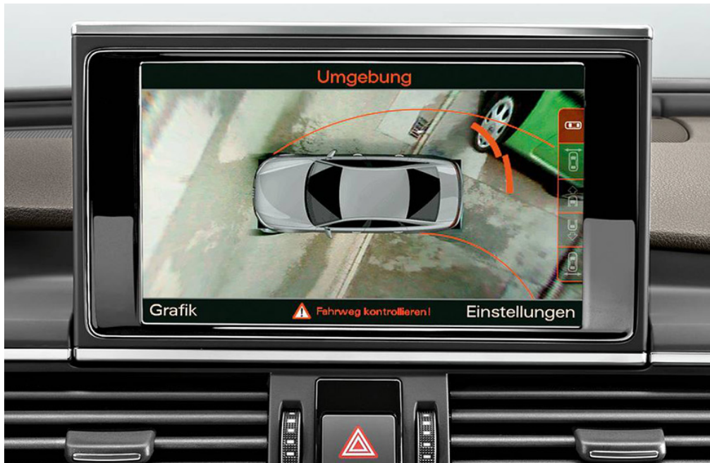
Kuva 7. Audin ympäristökamerajärjestelmän lintuperspektiivinäkymä. Kuva on yhdistelmä neljän kameran kuvasta, mutta kalibroinnilla saadaan kuvien yhdistelmä näyttämään realistiselta ja korjattua vääristymät [Top View Camera.]
