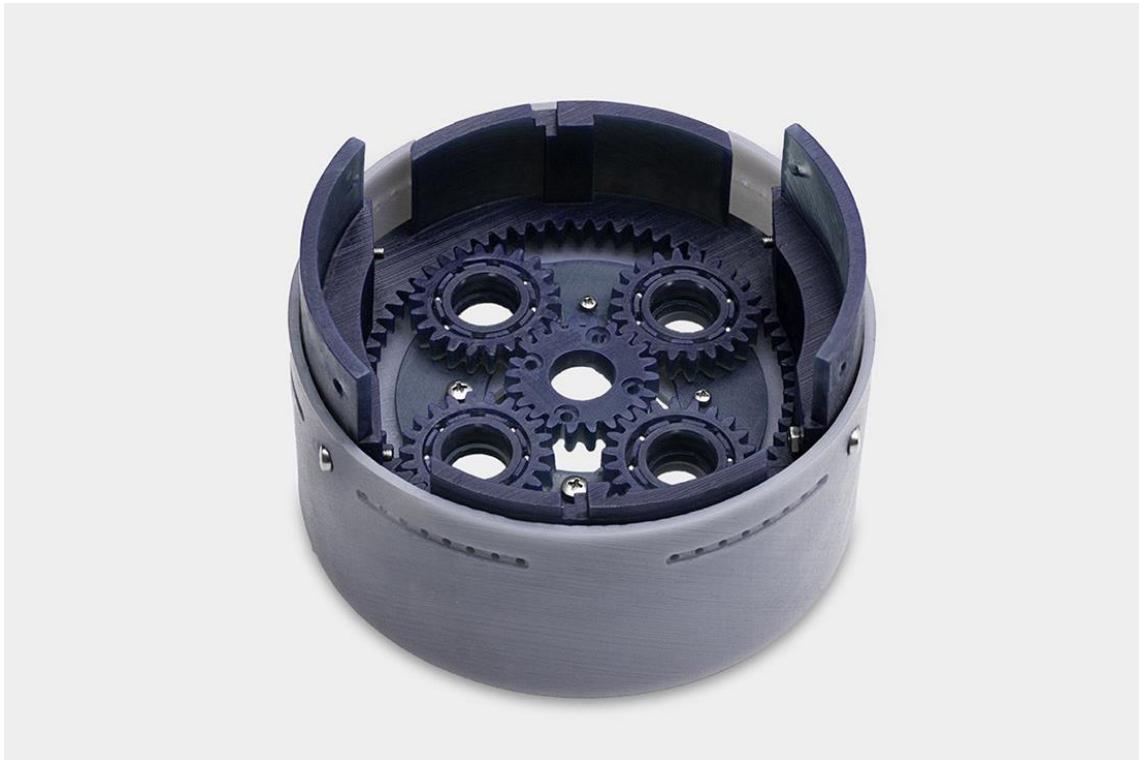
Kuva 14. SLA-menetelmällä valmistettu prototyypikokoonpano (3D Hubs 2018c).
