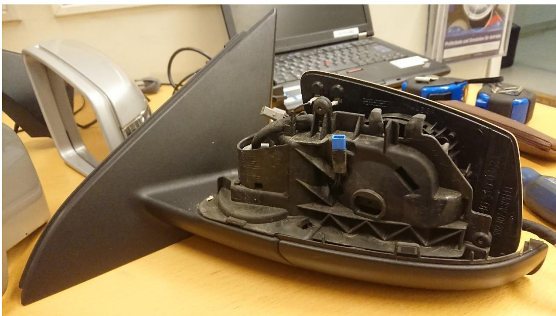
Kuva 43. Alkuperäinen peiliyksikkö avattuna.
