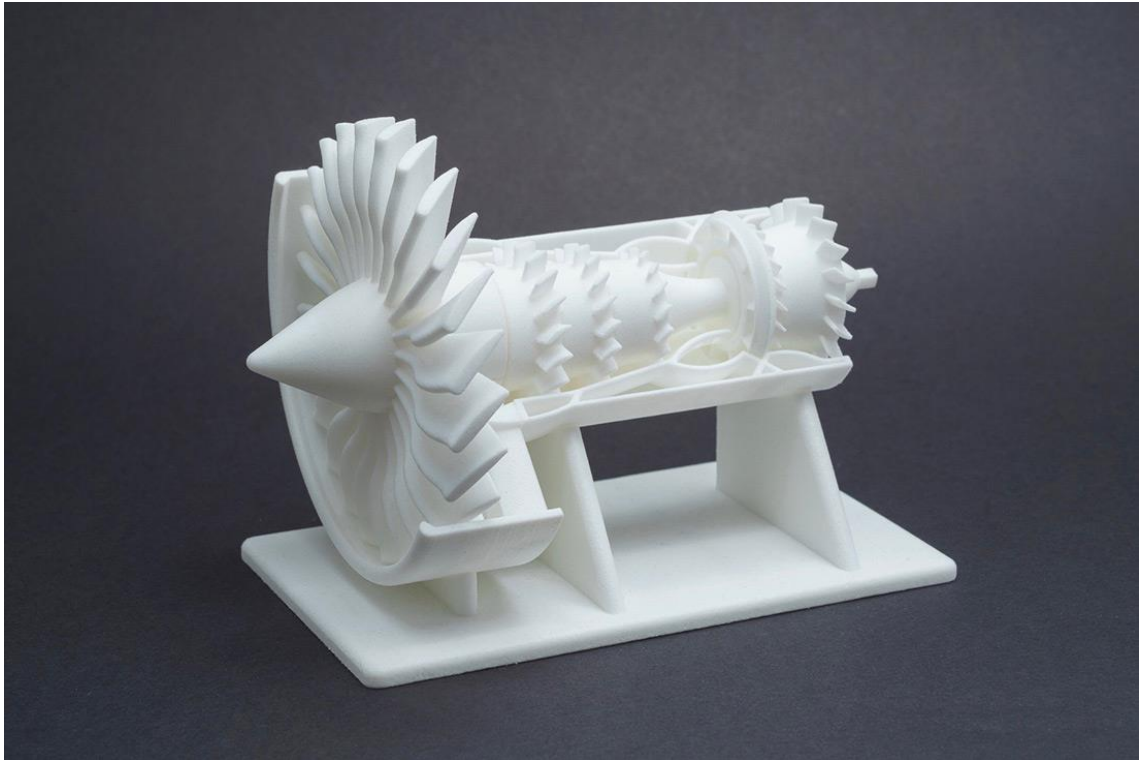
Kuva 22. SLS-menetelmällä valmistettu suihkuturbiinin pienoismalli (3D Hubs 2018c).
