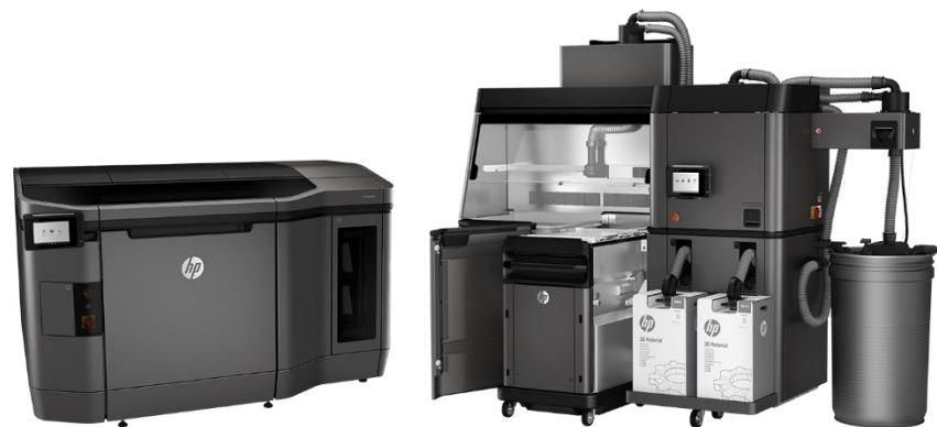
Kuva 24. HP MultiJet Fusion 3D 4200 MJF -tulostusasema (All3DP 2016a).
