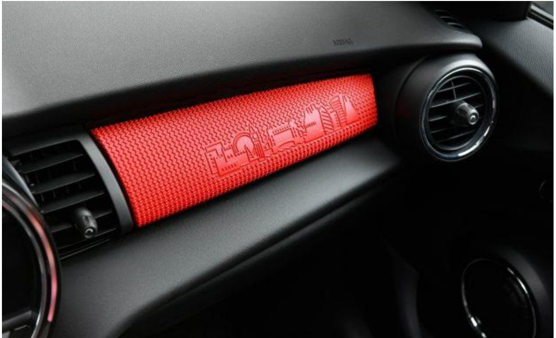
Kuva 32. 3D-tulostettu koristelista Mini Cooper -autossa (Car and Driver 2017).
