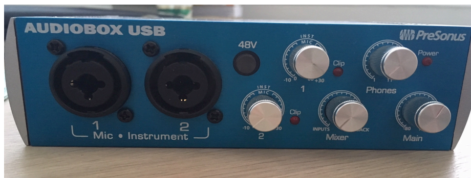
Kuvio 7. PreSonus AudioBox, jonka avulla voi säätää mikrofonin asetuksia.
