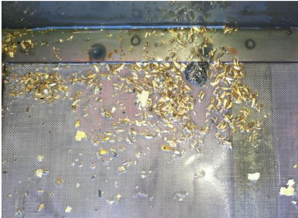
Kuvio 13. Vaurioituneen karamurskaimen kiertovoiteluöljysäiliön siivilä. (Kokko 2018.)
