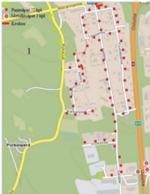
KUVA 5. Pistesijoituspiirustus valaisimista ja pylväistä (23, s. 50).
