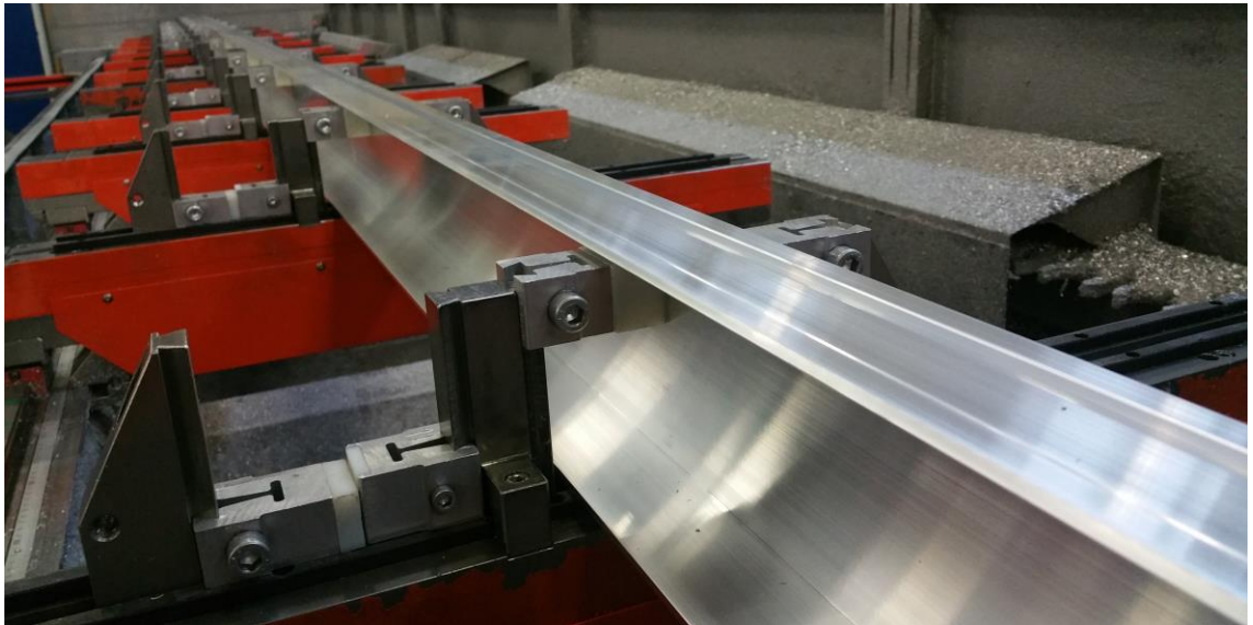
KUVA 4. Kiinnityspalat ja kiinnitetty työkappale (Matias Paavola 2018)
