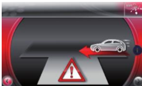
Kuva 6. ICA-järjestelmä, joka varoittaa kuljettajaa risteävästä liikenteestä [14, s. 13].
