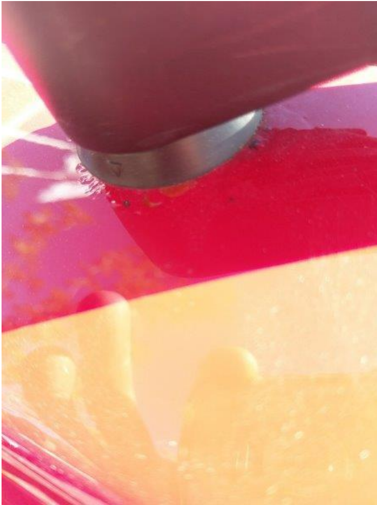
Kuva 4. Kuva epäkohdasta, ruostetta lasinpyyhkijän läpiviennin kohdalla
