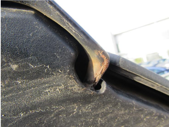
Kuva 10. Ruostetta takaluukun sisäpuolella
