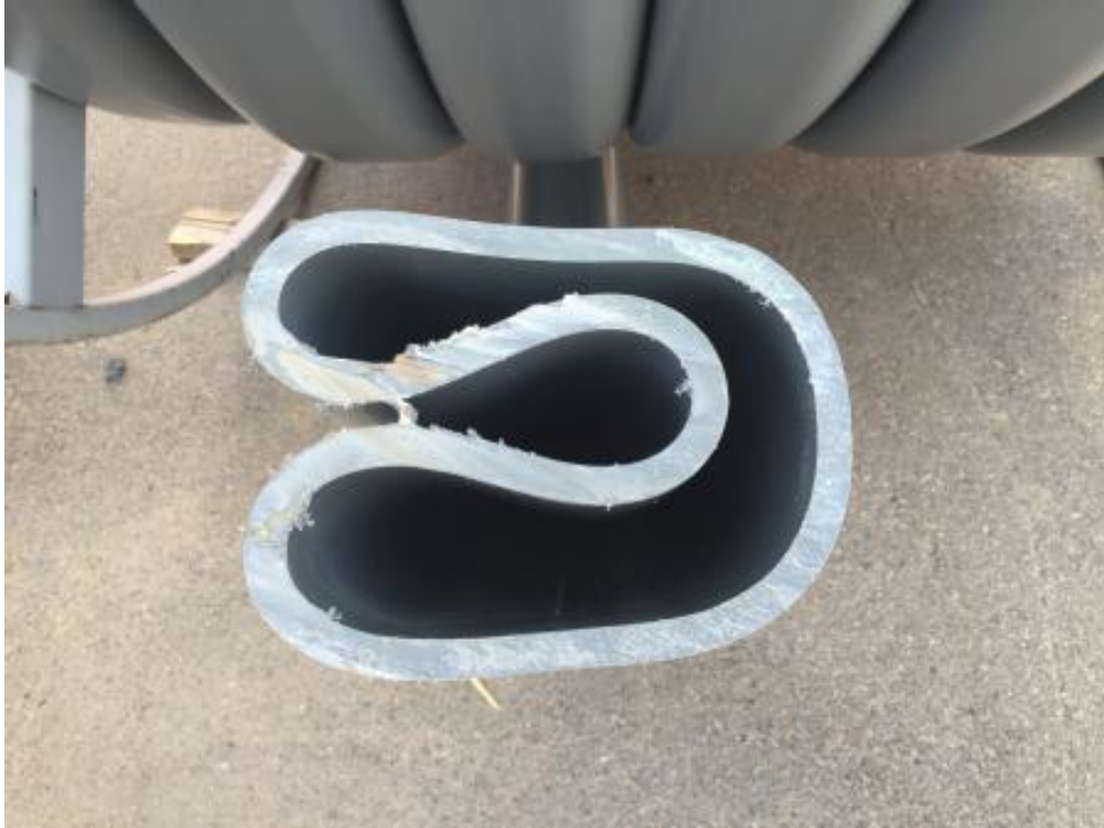
Kuva 9. Laskostettu Renos Rauliner -muotoputki [4]
