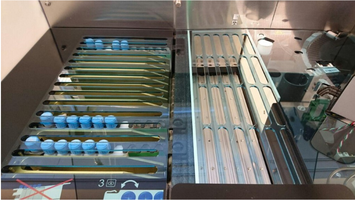
KUVA 5. Vasemmalla reagenssikammio sekä oikealla tyhjä näytekammio
