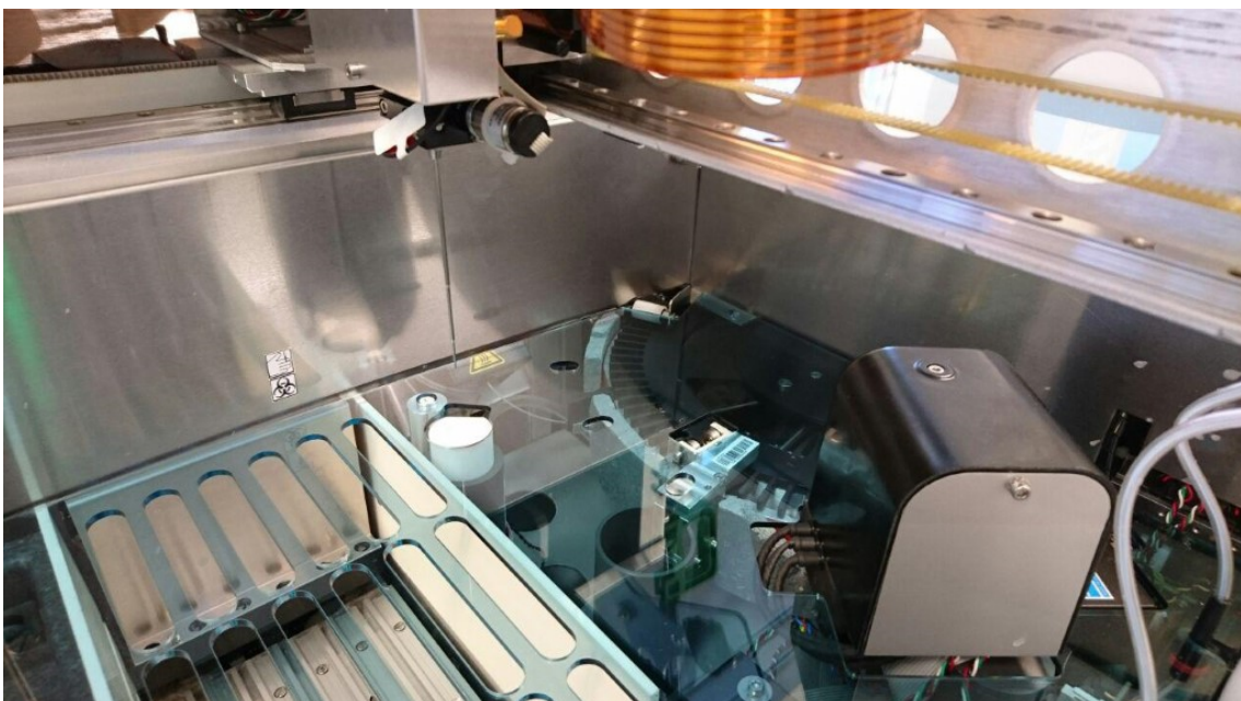
KUVA 9. Keskellä vasemmalla pipetointineula, suojapleksin alapuolella kyvettikelkka
