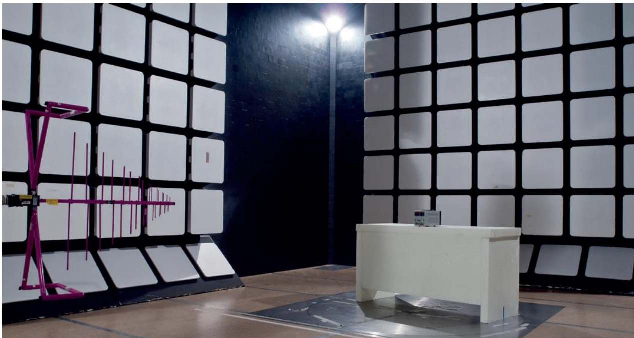
KUVA 1 Savonia EMC-laboratorion SAC-testauskammio, emissiotestaus-setup.
