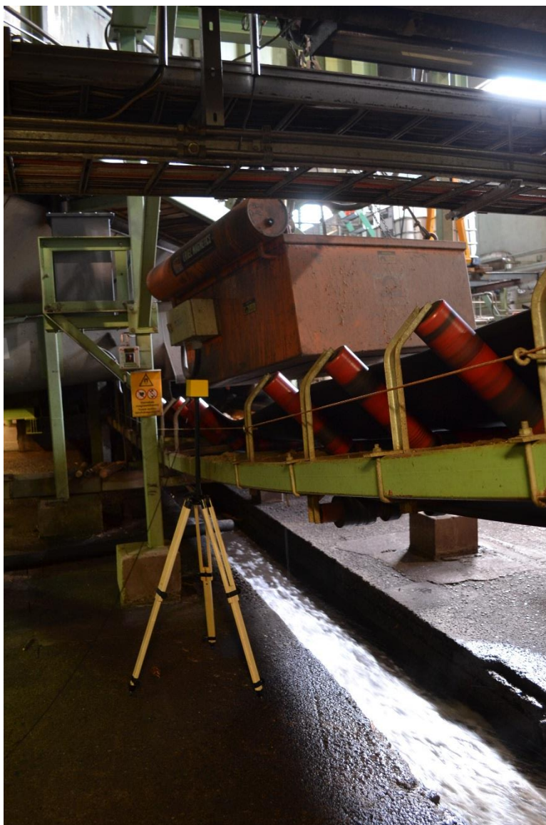
KUVA 13 Kuorimon raudanerotusmagneetti liukuhihnan päällä. Mittausanturi 0,2 m päässä magneetista.
